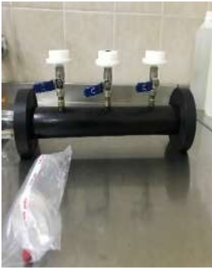
Figura 9: Equipo de Filtración por Membrana (manifold) y monitores de membranas con poros de 0,45 \mu\text{m} .
