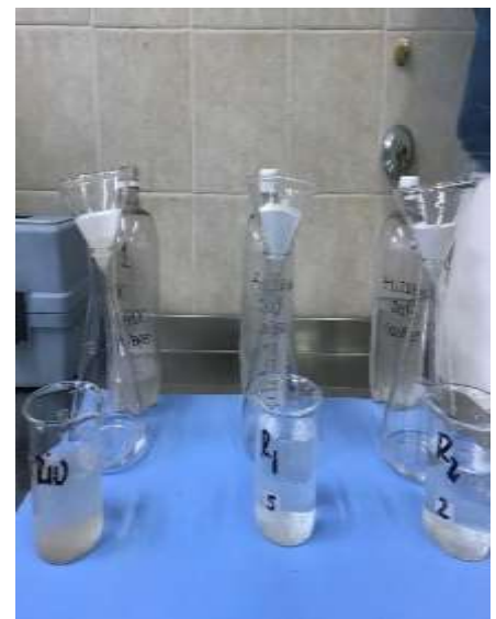
Figura 8: Filtrado 1 250 ml de muestra homogeneizados se los filtró utilizando un filtro de 28 \mu\text{m} de tamaño de poro para quitar interferencias de la muestra.
