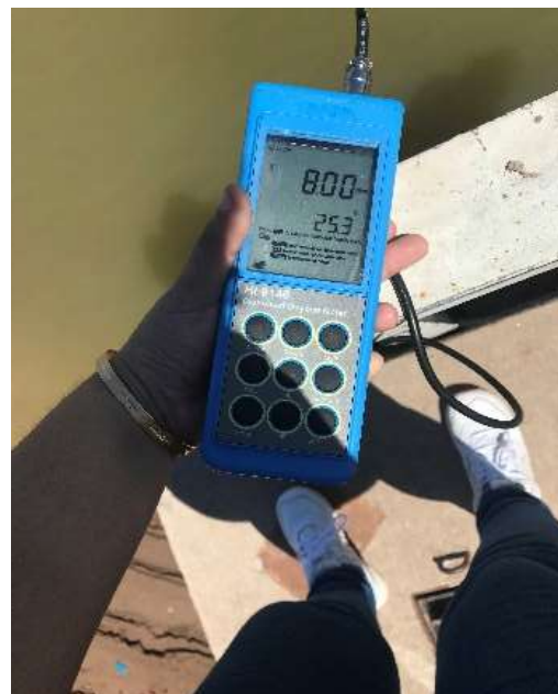
Figura 6: Determinación OD por colocación de sonda directamente en el cuerpo de agua.
