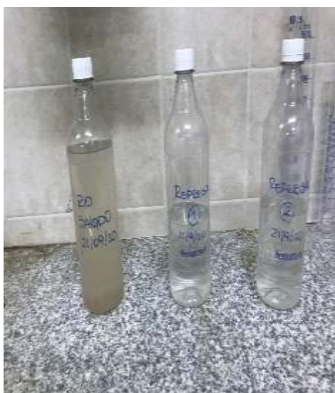
Figura 8: Filtrado 1 250 ml de muestra homogeneizados se los filtró utilizando un filtro de 28 \mu\text{m} de tamaño de poro para quitar interferencias de la muestra.
