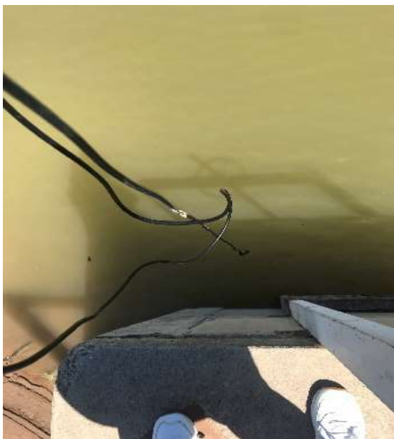
Figura 6: Determinación OD por colocación de sonda directamente en el cuerpo de agua.
