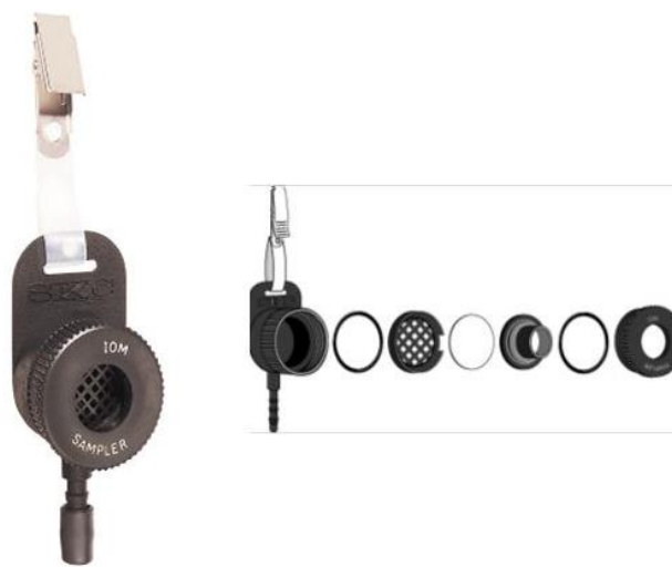
Fig. 6: Componentes del muestreador IOM.
