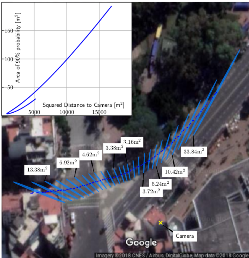
Figura 6.8: La retro-proyección de la traza del vehículo al plano mundo con incerteza (se grafica una elipse cada tantas).
