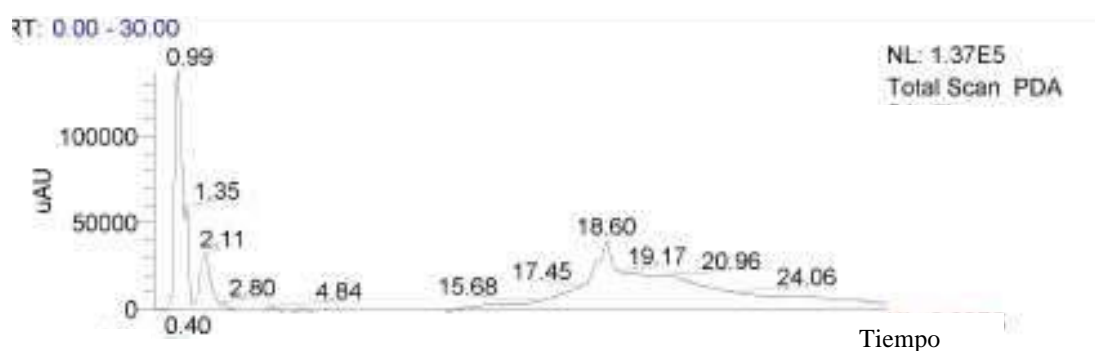
Figura 36: Análisis por HPLC de una muestra obtenida con E. coli ATCC 23513, la cual podría contener dU como subproducto de reacción (Tr 2.11 min).
