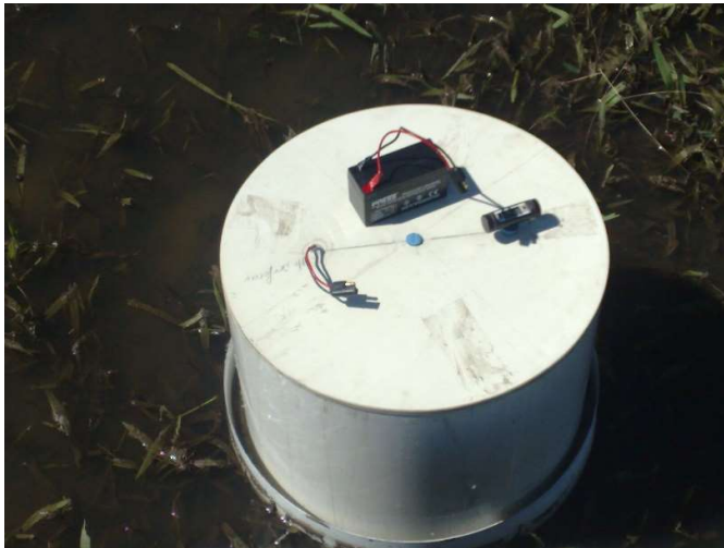
Figura 11. Cámara estática para toma de muestras de gas metano. E. E. A. El Sombrero. INTA. Corrientes.
