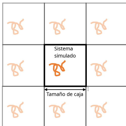
Figure 2.5: Ilustración de las Condiciones Periódicas de Contorno en 2 dimensiones, en una caja cuadrada y con sus celdas imágenes más próximas.
