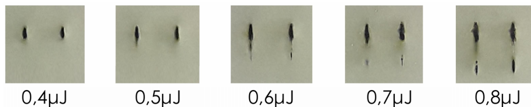
Figura 5.2: Tracks en LiNbO_3 según energía de pulso. A medida que la energía de escritura se incrementa, también aumenta sensiblemente el área de daño en el material.
