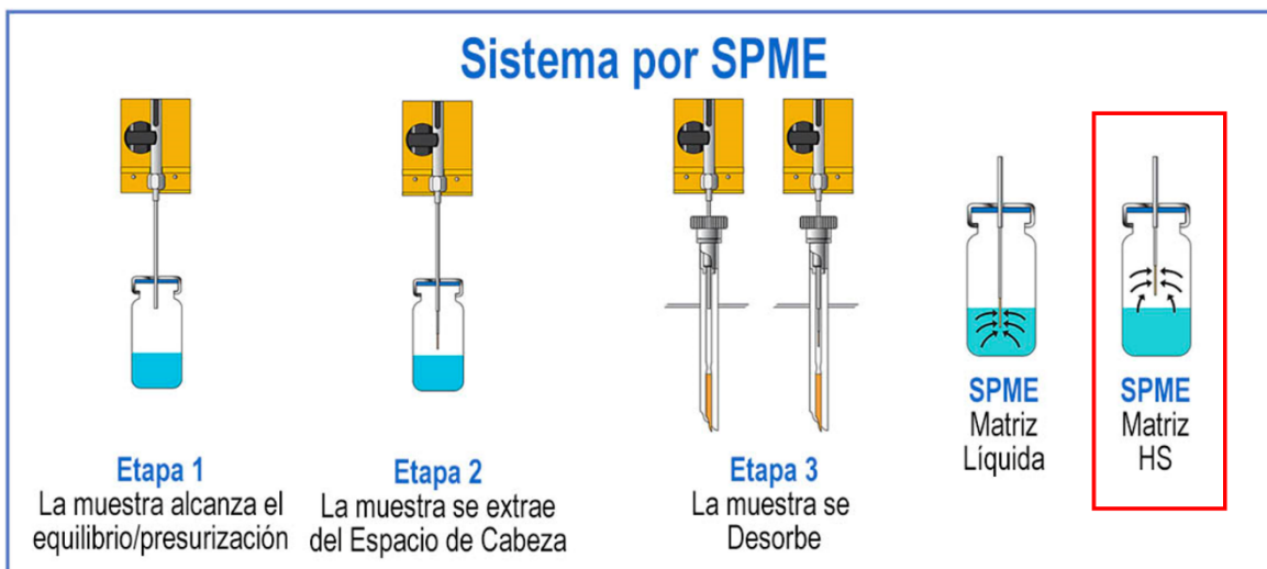
Figura 2.1. Esquema del proceso SPME-GC
