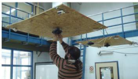
Figura 9.12: Prototipo del sistema de reproducción y sensado de Ocupación Invisible. Se observa claramente la ubicación de los parlantes con sus sensores, y los sensores de movimiento (cubos blancos) que los rodean.
