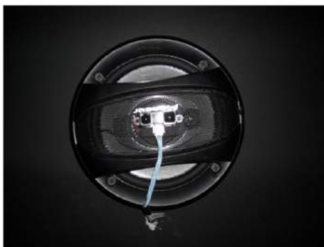
Figura 9.11: Se observa un parlante ubicado en el techo de la instalación con el sensor Sharp adosado, ambos apuntando hacia abajo.
