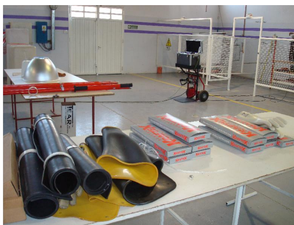
Equipo de control de tensión. Insumos que serán verificados.
