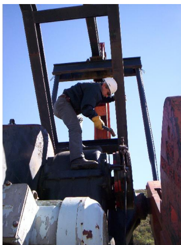
Imagen de maniobra riesgosa para poner una traba de seguridad en el Aparato Individual de Bombeo.
