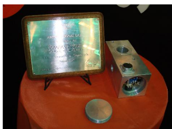
Supervisor de fallas en boca de pozo
