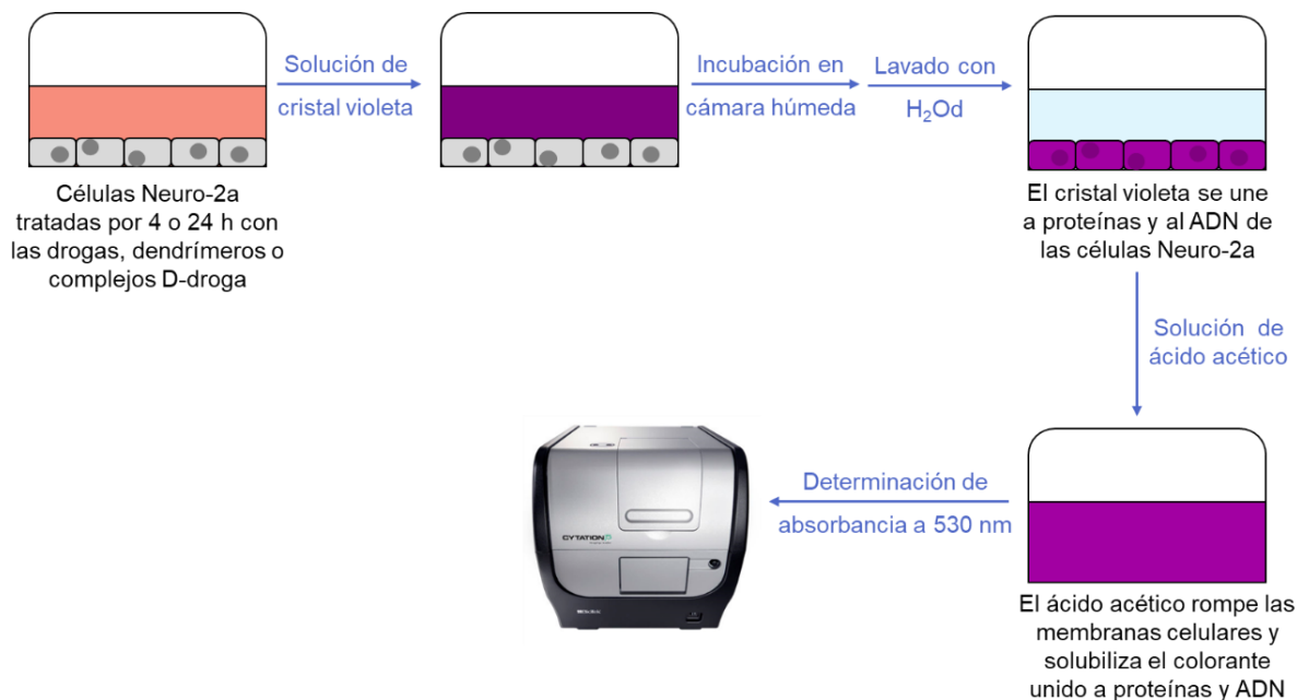
Figura 2.14 – Esquema de la determinación de viabilidad celular por tinción con cristal violeta. Las células se incubaron con una solución de CV en cámara húmeda. Las monocapas teñidas se lavaron con agua desionizada. Luego, se agregó una solución de ácido acético para permeabilizar las células y solubilizar el colorante. Finalmente, se determinó la absorbancia a 530 nm, parámetro que es proporcional a la cantidad de células unidas a la placa.
