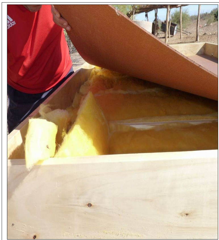
Imagen N° 12: La lana de vidrio colocada en la parte inferior de la batea permitió aumentar la aislación térmica del destilador.
