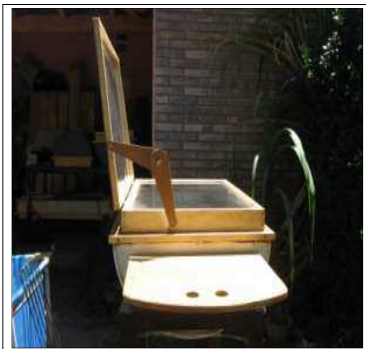
Imagen N° 10: Para regular el ángulo de apertura del reflector fue diseñado un sistema de compás con mariposa.
