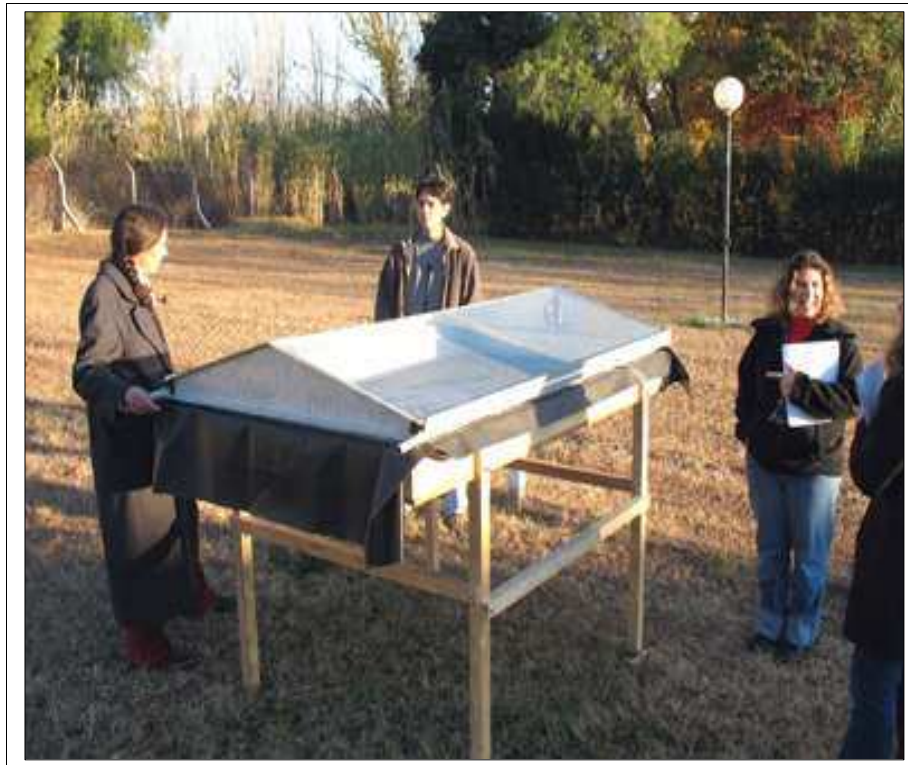
Imagen N° 5: El primer prototipo de destilador solar asimétrico fue puesto a prueba en la ciudad de Mendoza para evaluar su rendimiento.
