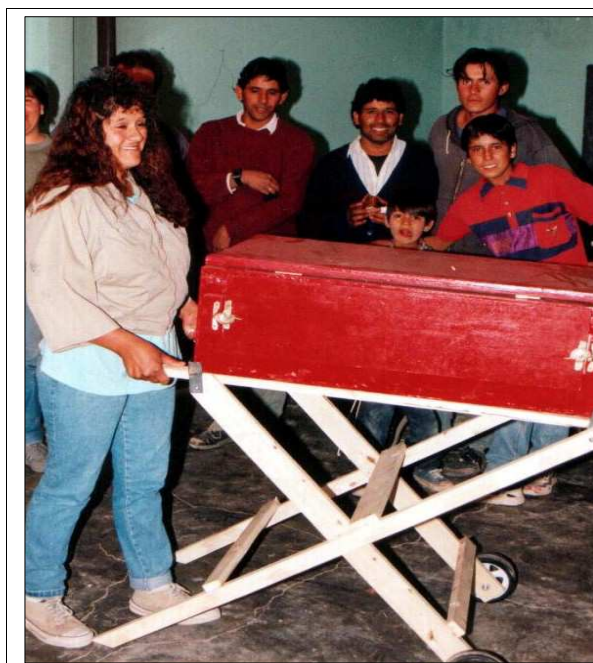
Imagen N° 2: El soporte móvil del horno solar fue incorporado por pedido de los usuarios
