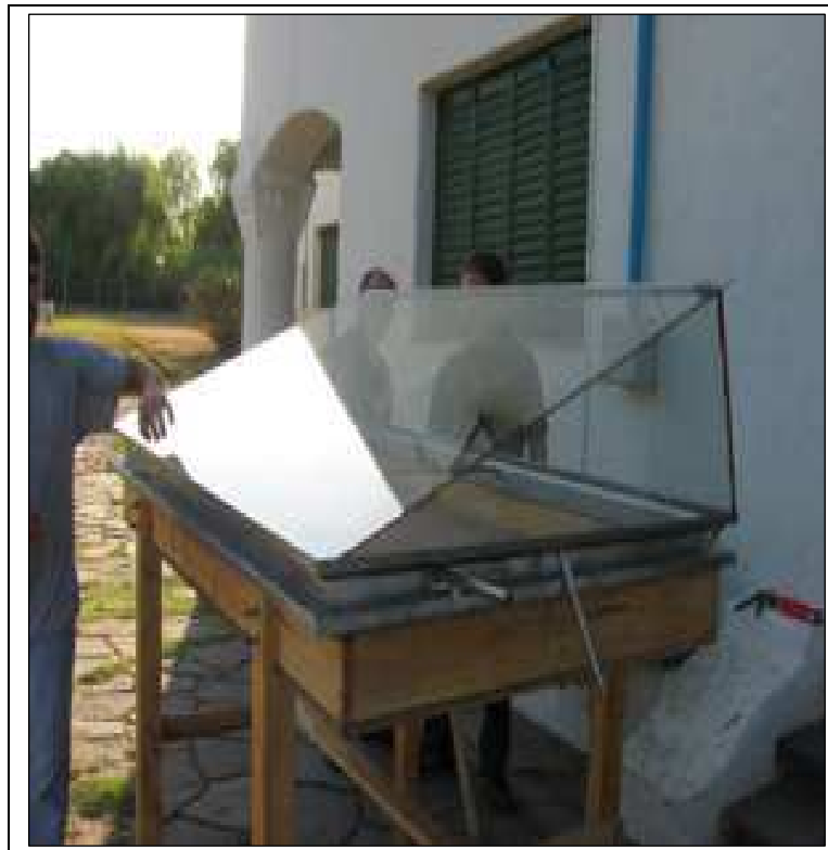
Imagen N° 6: Destilador solar con cúpula asimétrica reemplazó al prototipo original.
