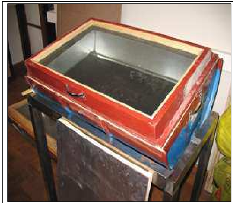
Imagen N° 7: El primer prototipo de horno solar de tambor metálico construido para el proyecto presentaba una ventana con doble vidrio unida al tanque con un sistema de bisagras. En la foto se puede observar el reflector apoyado aún sin colocar.
