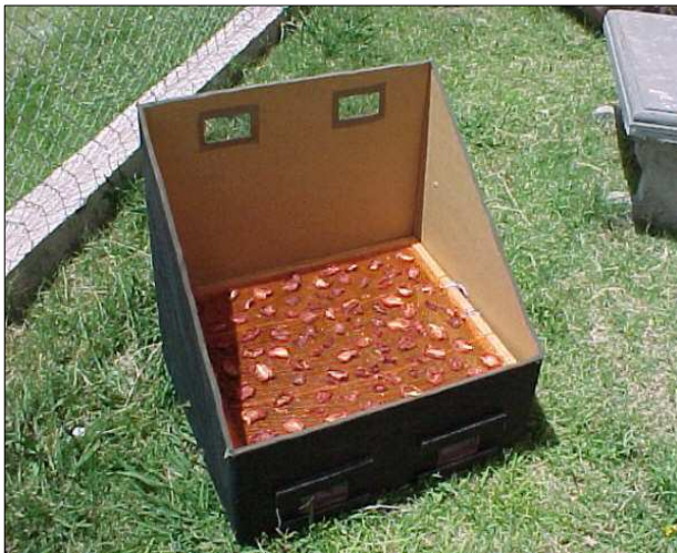
Imágenes N° 3 y N° 4: Los secaderos solares contruidos en Campo Pappa con materiales reciclados, permitieron desarrollar un micro-emprendimiento de producción de tomate, ajo y orégano secos.
