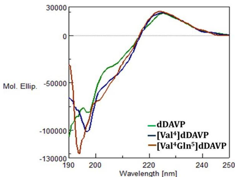
**Figura 18:** Espectro de CD de dDAVP, [Val<sup>4</sup>]dDAVP y [Val<sup>4</sup>Gln<sup>5</sup>]dDAVP en 2 mM de PBS.
