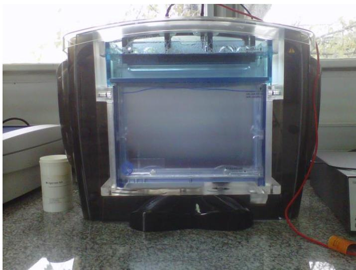
**Figura 33:** Segunda dimensión de la electroforesis bidimensional (2-DE).
