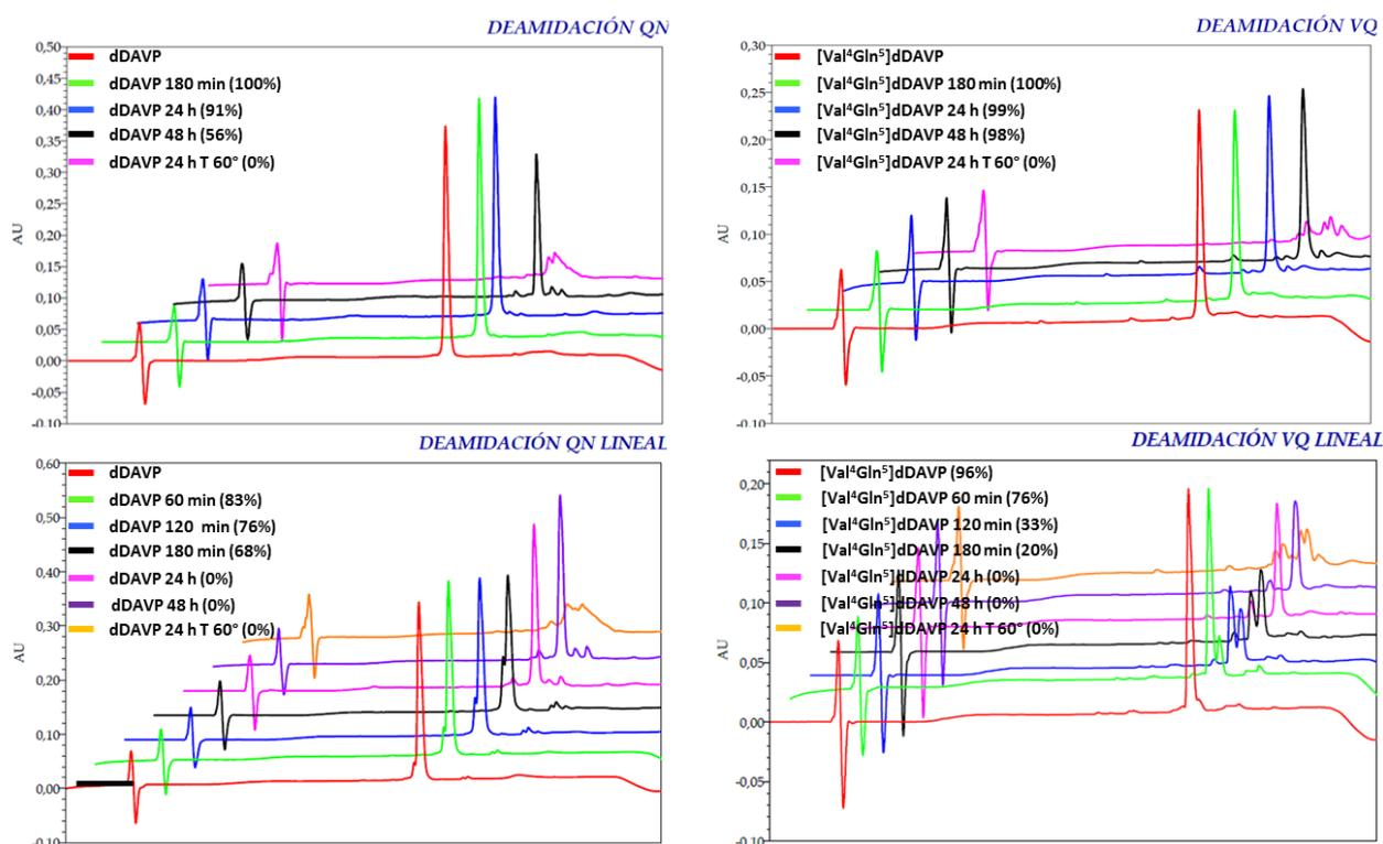
**Figura 19:** Deamidación de dDAVP (QN), su análogo [Val<sup>4</sup>Gln<sup>5</sup>]dDAVP (VQ) (paneles superiores) y sus respectivas versiones lineales (paneles inferiores) a diferentes tiempos y temperatura. Se indica el porcentaje de molécula no amidada.
