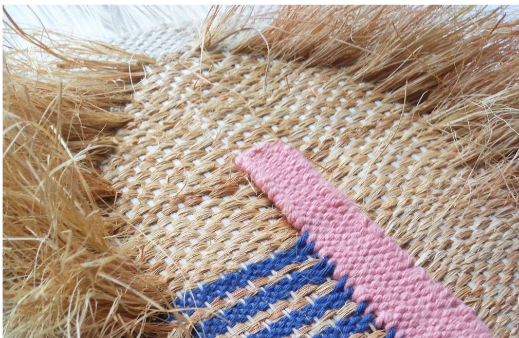
Fig.9 Tejido plano con fibras de formio combinadas con hilos de algodón, muestra producida para esta investigación
