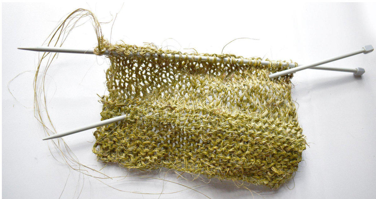
Fig.10 Tejido de punto realizado enteramente en fibras de formio. Muestra realizada para esta investigación.
