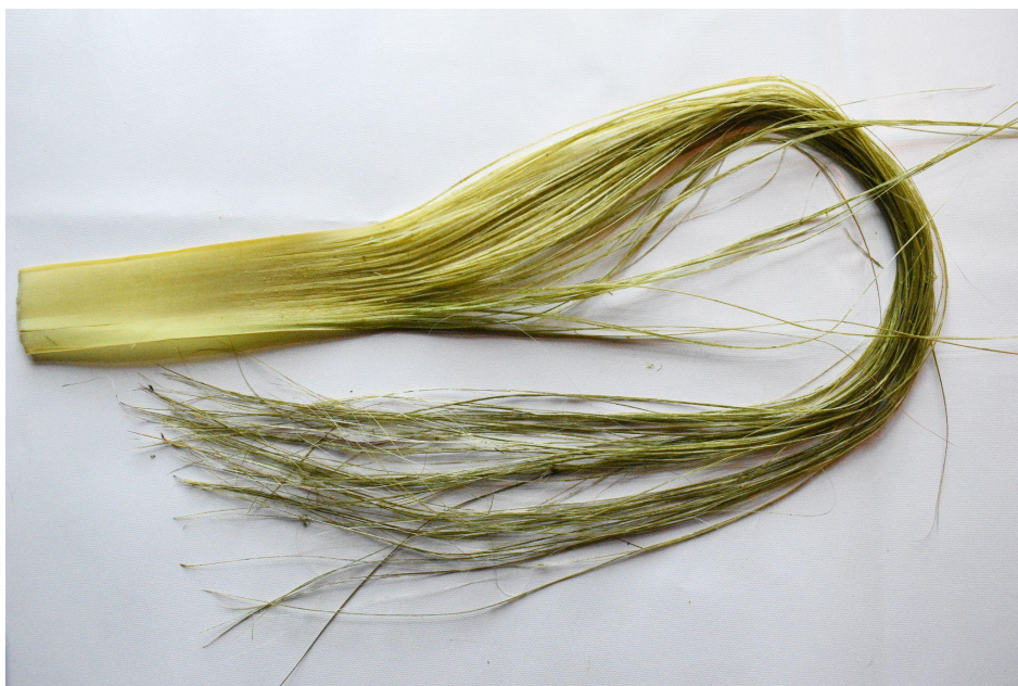
Fig.8 Procesos de obtención de la fibra. Hoja de formio con proceso de desfibrado mecánico(con peine de acero). Registro de la propia experimentación.
