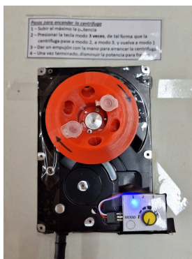
Centrífuga de Bajo Costo DIY, a partir de Arduino Fuente: CUIC
