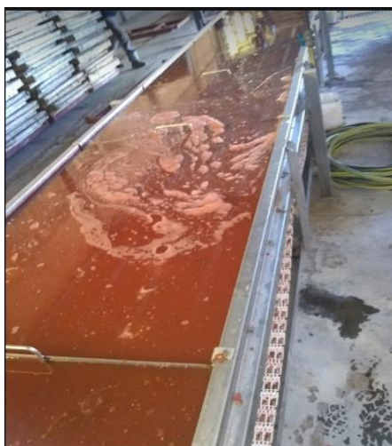
Figura N° 14 Cinta de transporte de tomate en inmersión completa de Metabisulfito 9 min.
