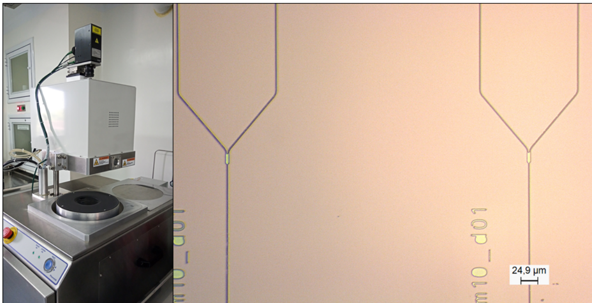
Figura 6.14: Izquierda: Equipo comercial Oxford Plasmalab 80Plus para realizar etching . Derecha: Foto capturada con microscopio Leica de un divisor de potencia 1x2, después de ataques RIE.
