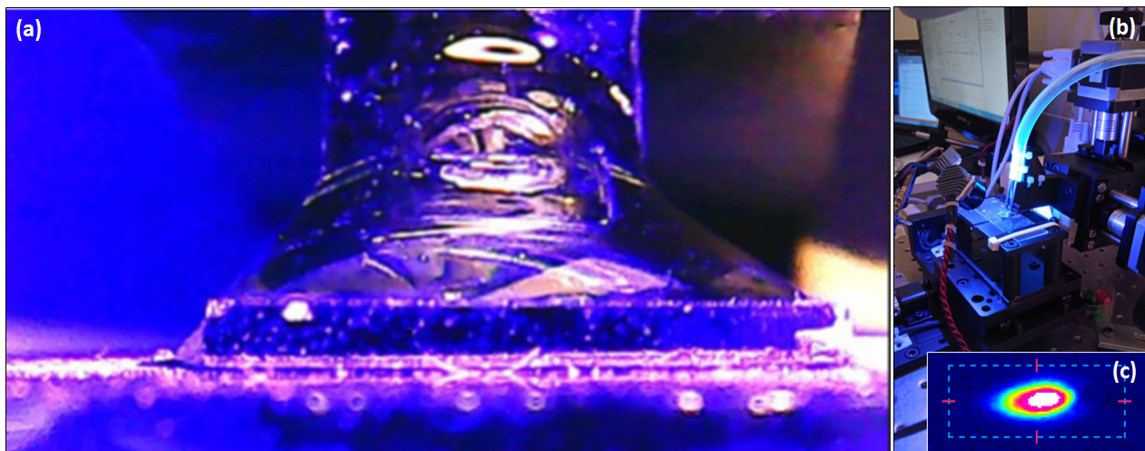
Figura 7.23: (a) Se muestra una fotografía bajo iluminación ultravioleta durante el último paso del proceso de curado. Esta imagen nos permite apreciar la forma y algunos detalles correspondientes al proceso de pegado. Como se puede observar se obtiene un pedestal sólido del pegamento, y a partir de éste se pudo obtener una pieza única y sólida para el conjunto chip-FA. (b) Se presenta una fotografía del sistema tomada durante el proceso de curado UV y (c) también se muestra un modo de una fibra desnuda correspondiente a una salida del splitter 1x8. Los modos se capturan con un Beam Profiler Analyzer LBP-4-USB de Newport.
