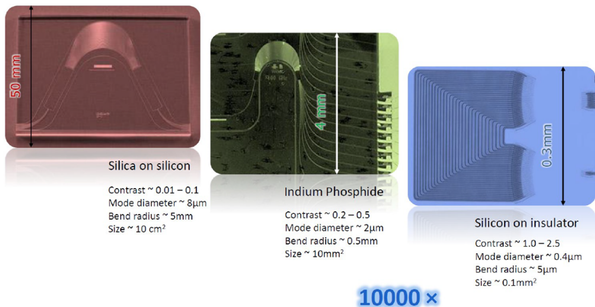
Figura 1.4: Imágenes de AWGs fabricados con diferentes nodos tecnológicos. Se compara el área final del dispositivo. A la izquierda guías de vidrio ( Silica on Silicon ), en el medio guías con materiales III-V ( Indium Phospide ) y la derecha guías de silicio ( Silicon On Insulator ).
