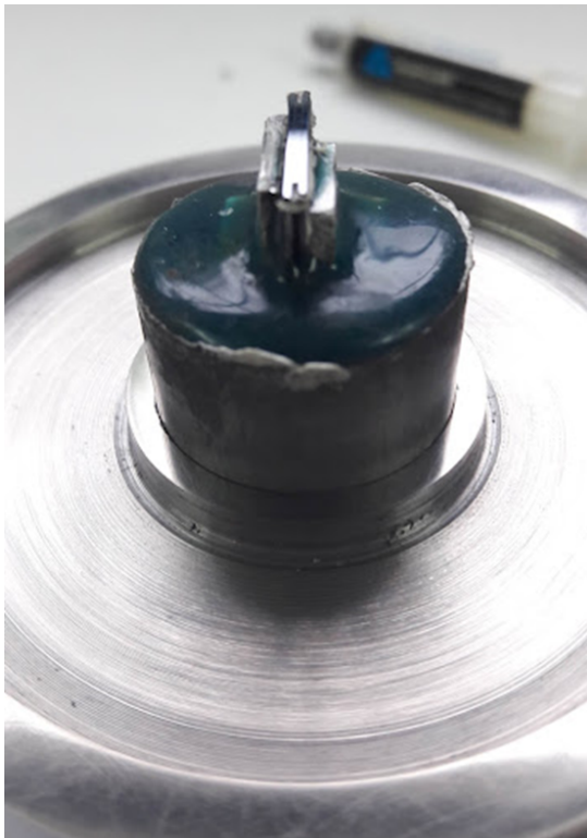
Figura 6.25: Pulido de los bordes de un chip de Nitruro de Silicio.
