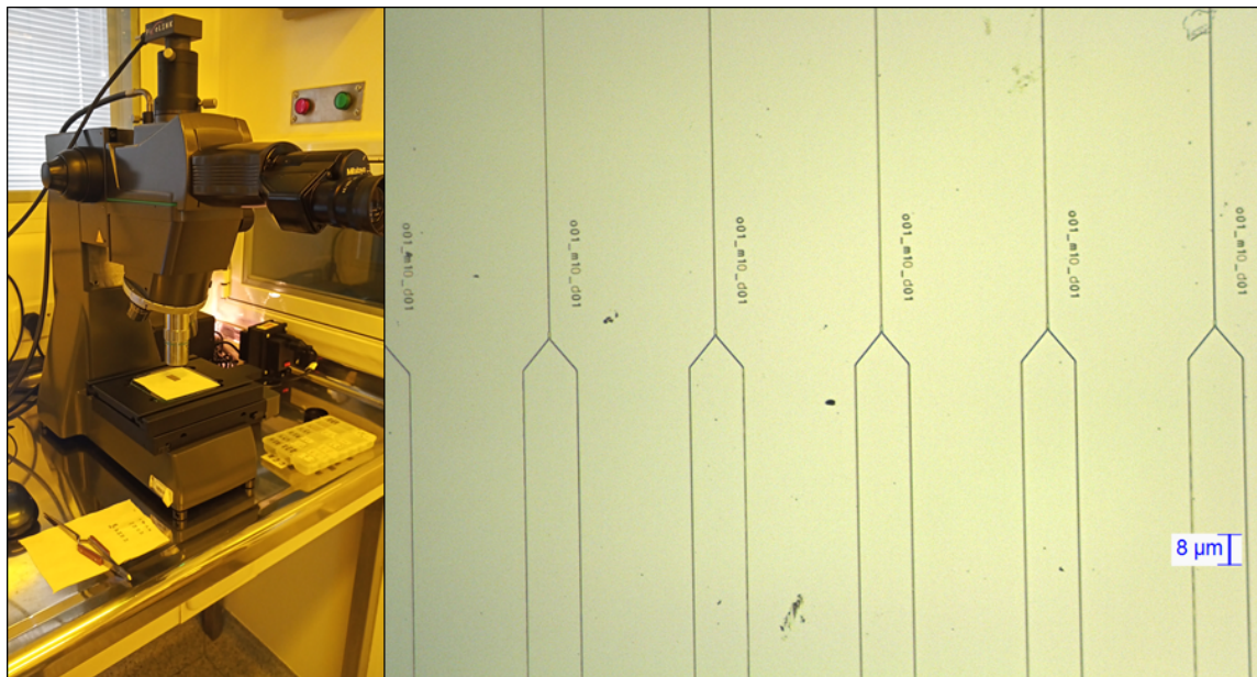
Figura 6.13: Izquierda: Control de patrones con microscopio. Derecha: Imagen capturada desde un microscopio Mitutoyo, se observan los patrones transferidos a la fotoresina luego del revelado.
