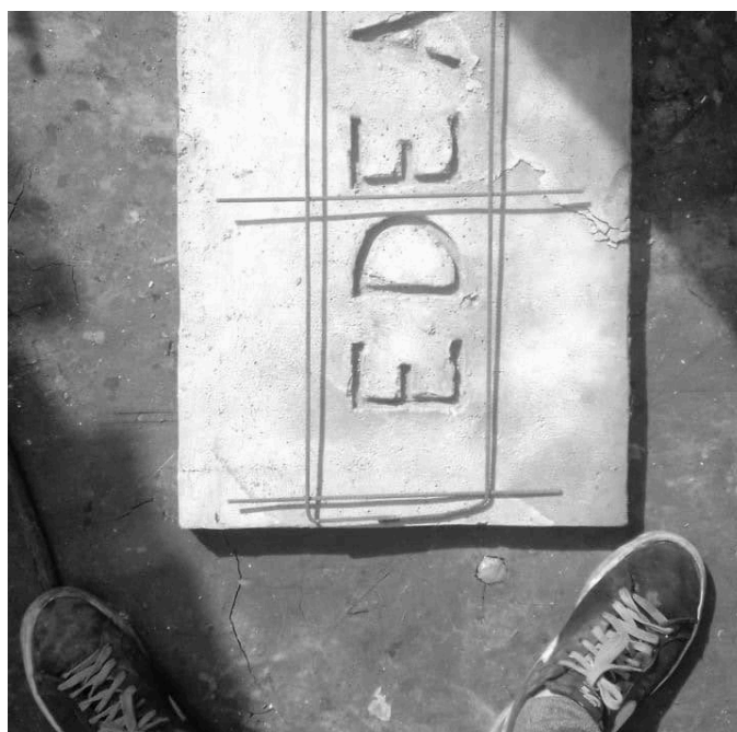
Figura 8. Loseta con su armadura de acero apoyada encima.
