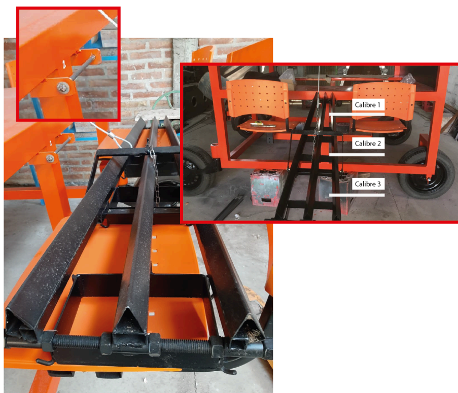
Figura 33. Detalle de las rampas calibradoras donde se observa las diferencias de los calibres y como se ensambla a la estructura principal de la estación de poscosecha. Fuente: Registro fotográfico construcción del prototipo funcional (2021) INTA EE Hilario Ascasubi.
