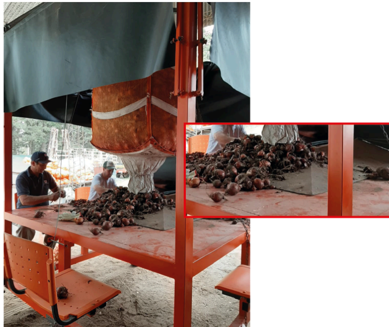
Figura 30. Detalle de la mesa contenedora de las cebollas cuando se eleva el Big Bag que permite que las mismas se deslicen hacia las mesas de trabajo y las cebollas no se caigan. Fuente: Registro fotográfico construcción del prototipo funcional (2021) INTA EE Hilario Ascasubi.
