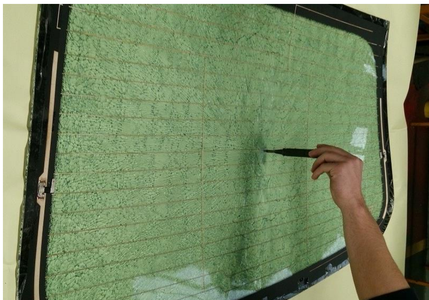
Fig. 9: Patrón de fragmentación de rotura de vidrio templado, obtenido de ensayo de rotura y fragmentación. Fuente: Laboratorio interno PAASA.
