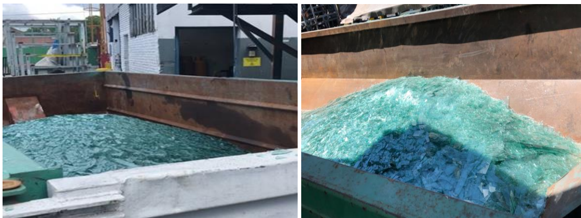
Fig. 12: Contenedores con fragmentos de vidrio certificado en sede industrial PAASA.
