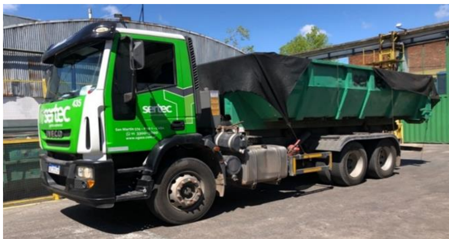
Fig. 2: Camión con contenedor roll-off para transporte de 10 Ton de vidrio de descarte en sede PAASA (vidrio automotriz) para retorno a horno VASA. Fuente: Elaboración propia.
