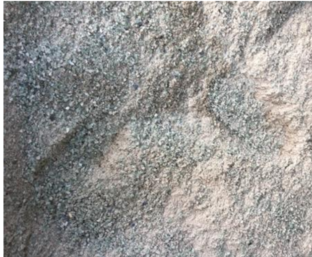
Fig. 14: Molienda de vidrio laminado listo para reutilización, luego de proceso de separación de rezagos de PVB, trituración y molienda. Fuente: Elaboración propia.
