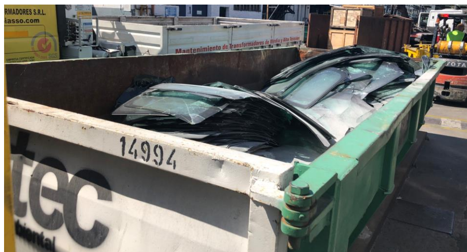
Fig. 34: Residuos de placas de vidrio laminado de seguridad (parabrisas descartados) en container roll-off. Fuente: Elaboración propia en sede PAASA.
