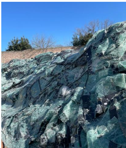
Fig. 16: Acopio a granel de residuos de vidrios laminados parabrisas, con PVB en su conformado, dispuestos en predio de empresa Molinos Ferba. Fuente: Elaboración propia.
