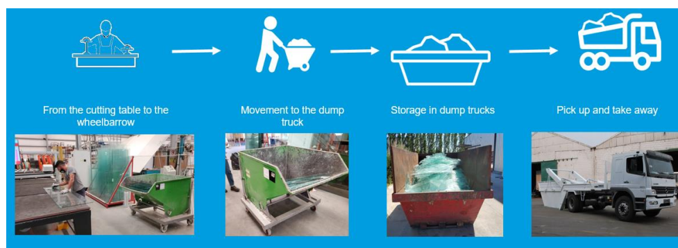
Fig. 25: Esquema de colecta y acopio de cascote de vidrio en volquetes. Fuente: VASA.
