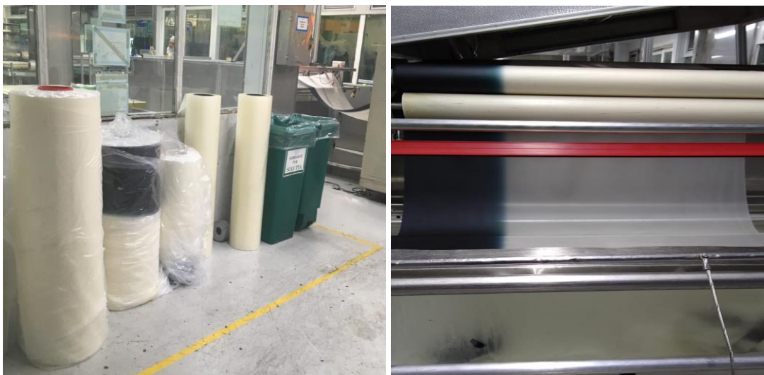
Fig. 22: Rollos de PVB a ser utilizados en proceso productivo en PAASA (izquierda) Lamina de PVB en proceso productivo en máquina conformadora (derecha). Fuente: Elaboración propia obtenida en sede industrial PAASA.
