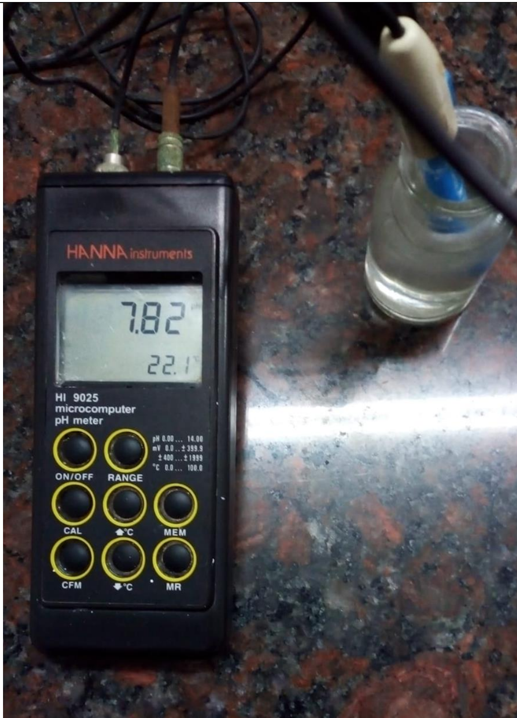
Figura 17: pHmetro utilizado para mediciones de pH en el río Ctalamochita.
