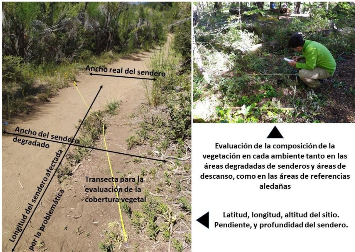
**Figura 4.** Técnicas de medición efectuadas en campo para la determinación de las características del sendero, y para la evaluación de la vegetación en el sendero y áreas de referencia. La cinta métrica amarilla en la imagen de la izquierda representa la transecta de 5 m de longitud dispuesta en forma diagonal al sendero. Fotografías tomadas por Axel Lehr en 2022.
