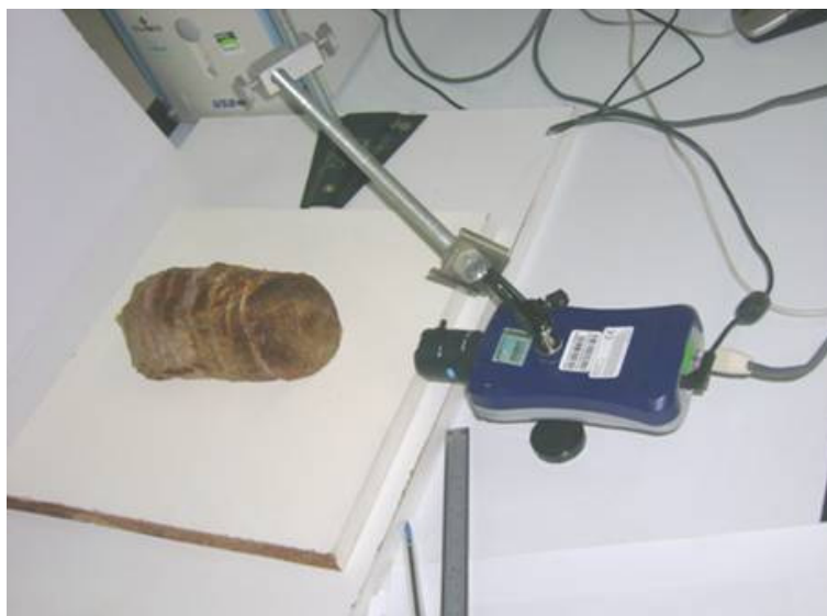
Fig. A.3. Sistema de visión computacional utilizado para realizar la adquisición de imágenes; la muestra observada es un corte de músculo semitendinosus luego de la cocción (Capítulo 2).
