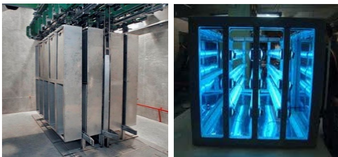
Fig. 14: Sala de irradiación de Ionics e interior de la cámara de irradiación, con fuentes de ^{60}\text{Co} .
