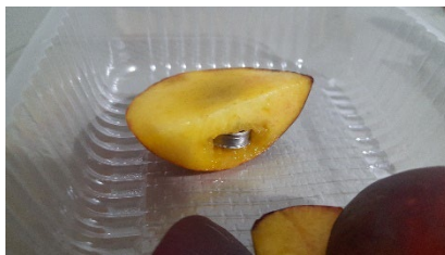
Fig. 26: Data logger , registrador de temperatura, insertado dentro del durazno.
