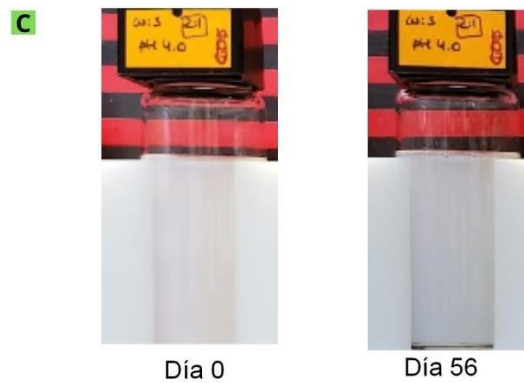
Figura 4.22. - Perfiles de T (A) y BS (B) a lo largo del tiempo de almacenamiento de NPs WPIS:SSPS 1:0,50 pH 4,0 con la aplicación de un tratamiento térmico. (C) Fotos de la muestra tanto para el día 0 como para el día 56 de almacenamiento.
