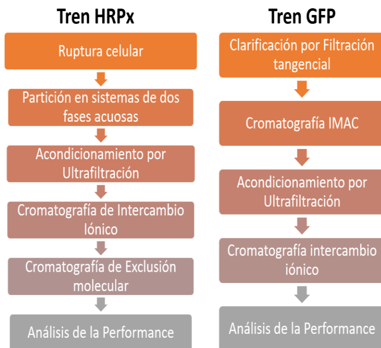
Figura 3. Esquema de las propuestas alternativas de TPI, con sus etapas de recuperación (ruptura, separaciones sólido-líquido y líquido-líquido), purificación (cromatografías) y evaluación de la performance del proceso para proteínas de interés biotecnológico.
