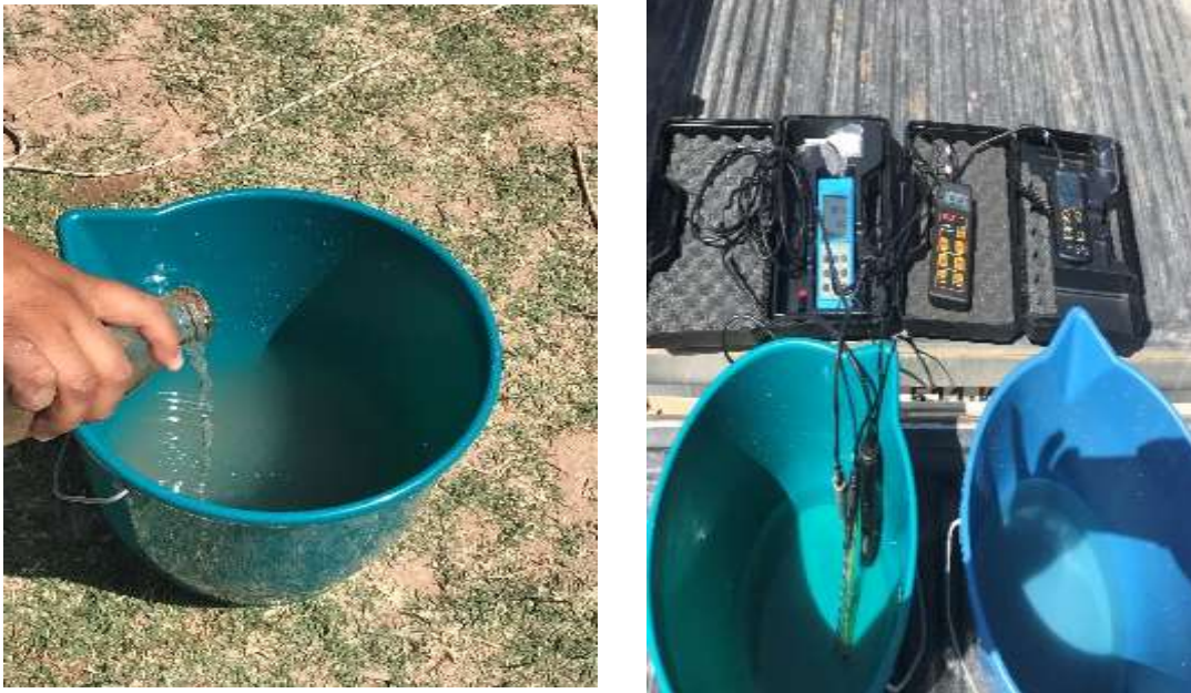
Figura 5: Determinación de parámetros físicos de muestra integrada
