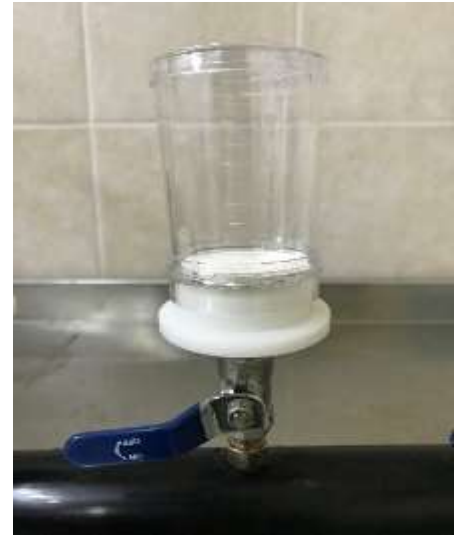
Figura 9: Equipo de Filtración por Membrana (manifold) y monitores de membranas con poros de 0,45 \mu\text{m} .
