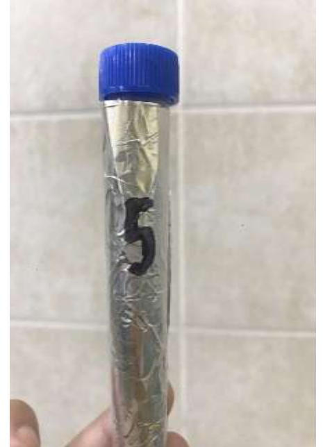
Figura 11: Preparación de las muestras para lectura espectrofotométrica antes de se realice la acidificación.
