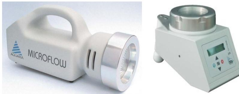
Fig. 1: Muestreadores de impactación multiorificio.
