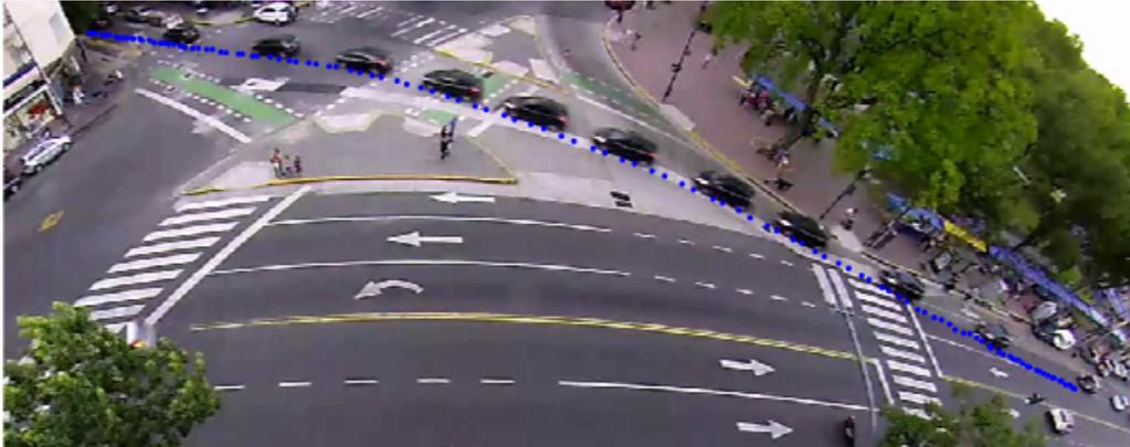
Figura 6.7: Posiciones detectadas del vehículo.
