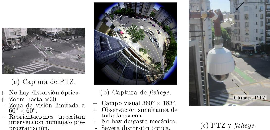
Figura 2.3: (a)-(b) Ejemplos de una captura y ventajas y desventajas de las cámaras PTZ y *fisheye* respectivamente. (c) Las dos cámaras montadas en un mismo soporte desde donde se tomaron las capturas.
