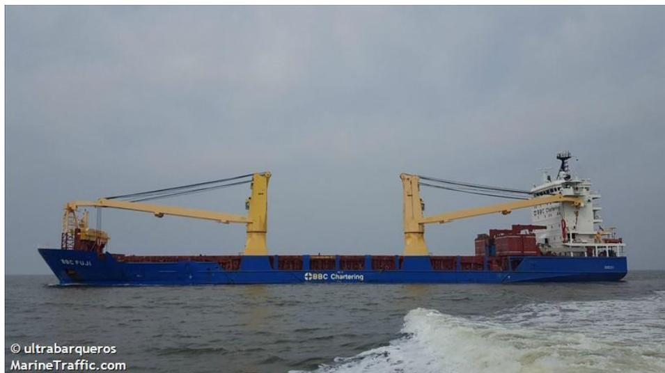
**Fuente:** Web Marinetraffic.com. Nombre BBC FUJI, eslora (largo) 120 metros, manga (ancho) 20.34 metros y calado (longitud hundida del buque) 6,20 metros.
