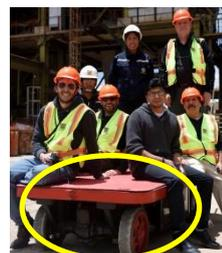
Este antiguo montacargas funcionaba con un motor eléctrico y baterías de plomo-ácido. El equipo de la PPB las sustituyó por una batería de 2kW.h de ión-litio ensamblada a base de celdas de 10 A.h producidas en La Palca. Tanto la carcasa como el sistema electrónico (Battery Management System) fue diseñado en La Palca.
