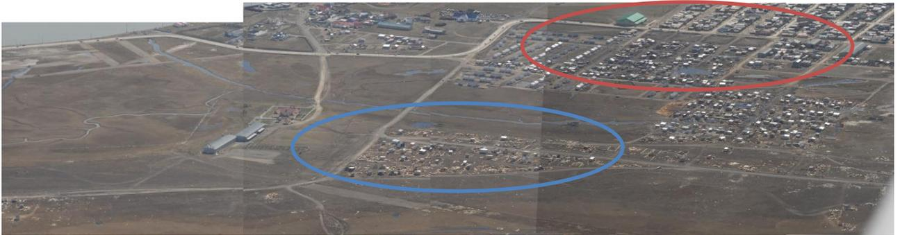
Imagen 2: Mosaico de imágenes Aéreas que permite apreciar con mayor precisión los sectores regulares (rojo) e irregulares (Azul) dentro del sector correspondiente a margen sur.
