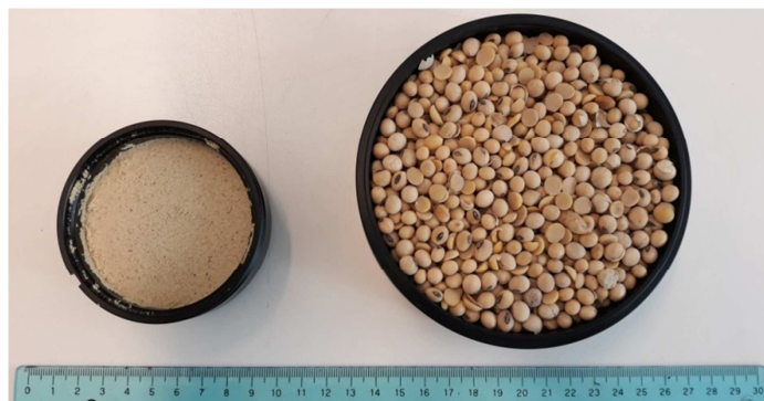
Figura 5. Copa chica y grande utilizada para materiales homogéneos y heterogéneos respectivamente, para la determinación por NIRS
