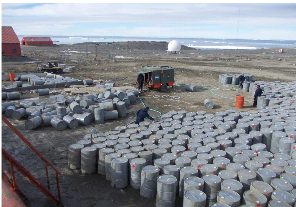
Fig. 19: Bombeo y trasvase de GOA desde tambores a las cisternas de Marambio. Fuente: Autor, 2014.
