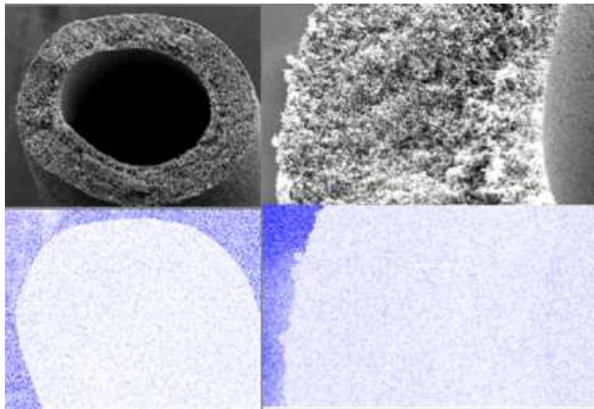
Figura 4.10 – Fotos SEM y  $\text{Cu}^{2+}$ -EDAX de corte transversal del material modificado con  $\text{Cu}^{2+}$ -IDA. Factor de magnificación  $400\times$  y  $90\times$ , respectivamente de izquierda a derecha. Visualización de la distribución homogénea del  $\text{Cu}^{2+}$ .
