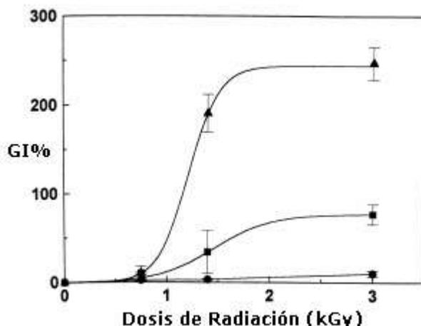
**Figura 4.2** – Efecto de la dosis de radiación sobre el grado de injerto de fibras huecas de PE hidrofiliadas inmersas en soluciones de 1% (●), 5% (■) y 10% (▲) de GMA en 50% metanol. Dosis total 3 kGy, fuente Gamma-cell  $^{60}\text{Co}$  (adaptada de Grasselli y col. [6]).
