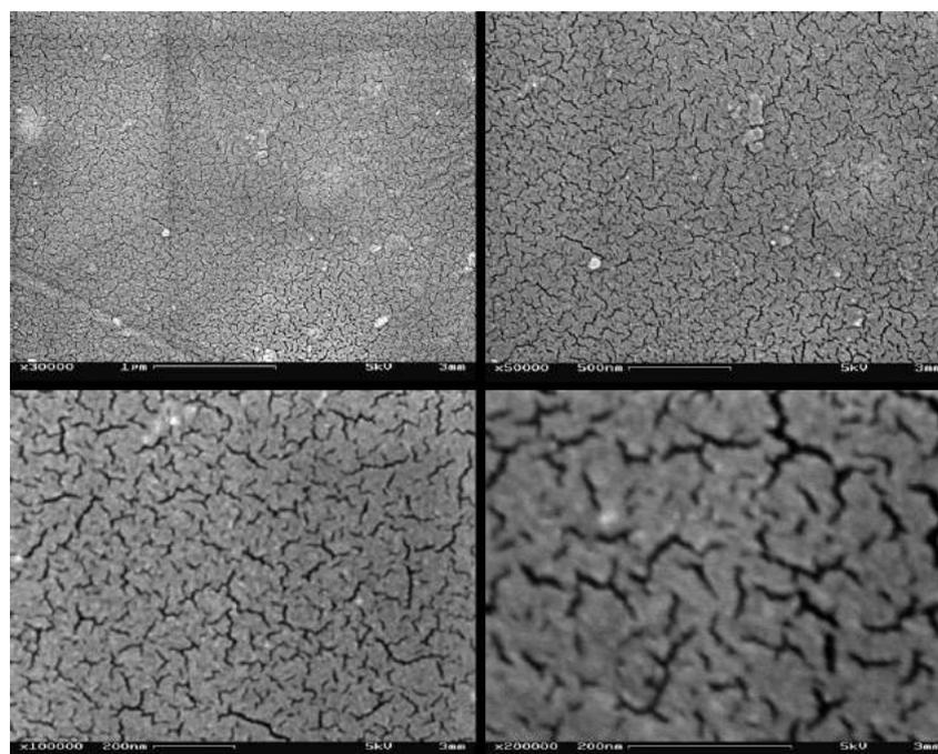
**Figura 5.7** – Micrografías electrónicas de PET sin modificar, bombardeadas con Kr (fluencia de  $3 \cdot 10^9$  iones/cm<sup>2</sup>)
