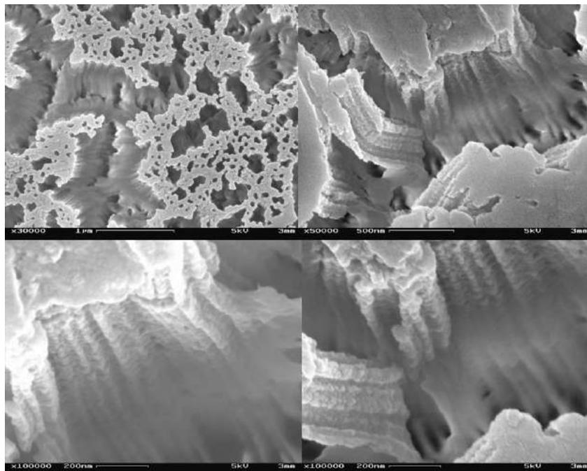
**Figura 5.14** – Micrografías electrónicas de PET bombardeado con fluencia  $3 \cdot 10^{10}$  iones/cm<sup>2</sup>; con marcado químico de 45 minutos (30.000x, 50.000x y 100.000x)
