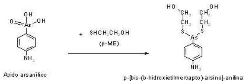
Figura 6.3 – Reacción de síntesis del ligando PBMA.
