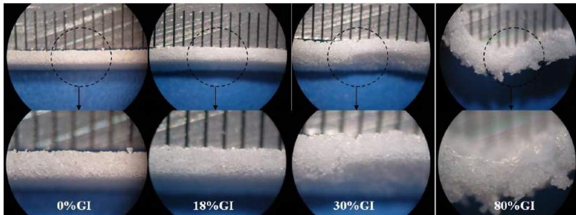
**Figura 3.6** – Fotografías de perfil de PE poroso preirradiado en aire y copolimerizado con AAm. De izquierda a derecha: 0% GI (M2 ó control de copolimerización), 18% GI (M6), 30% GI (M5) y 80% GI (M8). Aumentos en lupa: 1,5x (arriba) y 3x (abajo).
