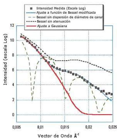
**Figura 5.16** – Ejemplo de los ajustes para ilustrar el efecto de los distintos elementos en el modelo. Realizado sobre una lámina de PET irradiada con iones Kr (fluencia de  $3 \cdot 10^9$  iones/cm<sup>2</sup>) y marcado químico de 45 minutos.
