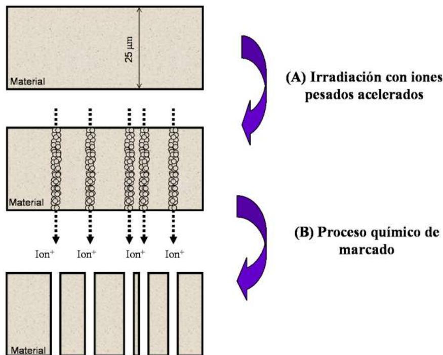
**Figura 5.1** – Esquema del proceso de formación de los poros perfectos en una película de material polimérico: A) Bombardeo con iones pesados acelerados, formación de la traza latente; B) Marcado químico para formar el poro.
