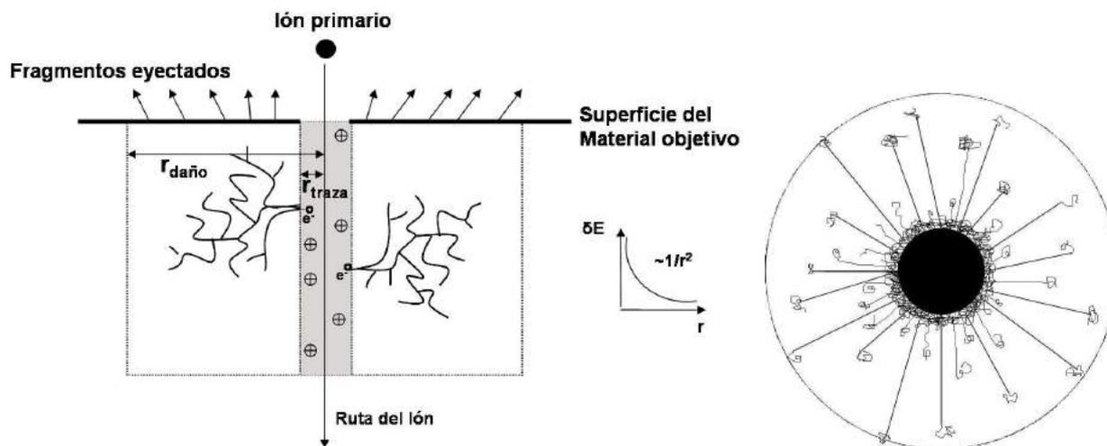
**Figura 5.2** – Esquemas de corte longitudinal de la deposición inicial de energía en el material y estructura radial propuestos para una traza latente en un polímero, con una zona central y una zona periférica o halo (adaptados de: Kopniczky [11] y Betz [12]).
