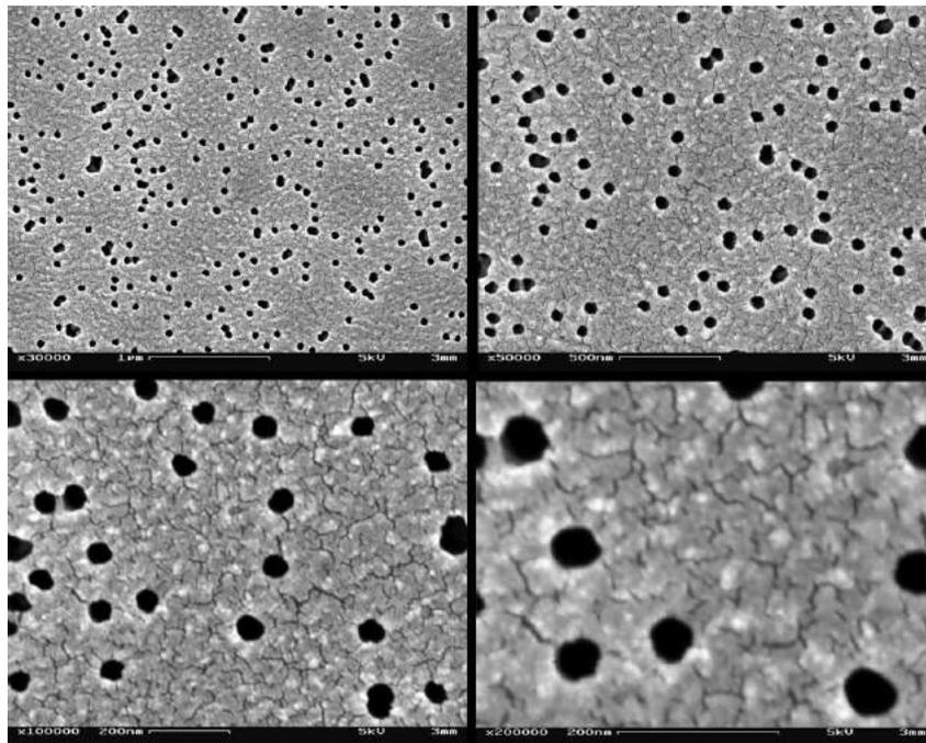
**Figura 5.9** – Micrografías electrónicas de PET (bombardeado con fluencia  $3 \cdot 10^9$  iones/cm<sup>2</sup>) con marcado químico de 45 minutos y posterior injerto radioinducido con 0,1 % v/v GMA (PET-R2).
