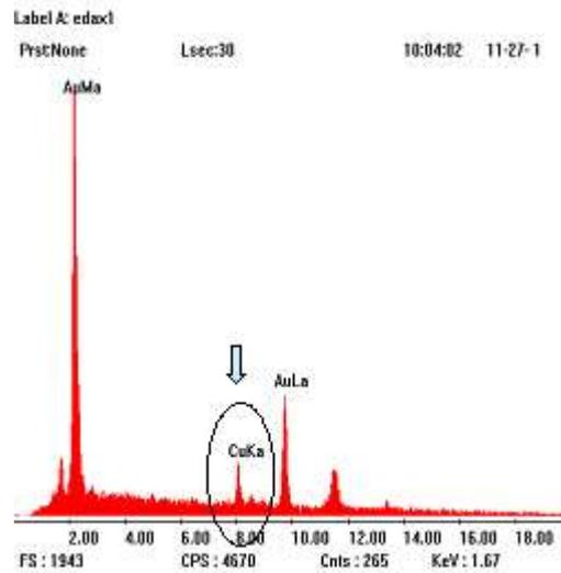
Figura 4.9 – Caracterización por Espectro de Emisión de Rayos X.
