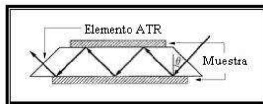
**Figura 1.6** – Esquema de la reflexión del haz de luz en la placa en ATR.
