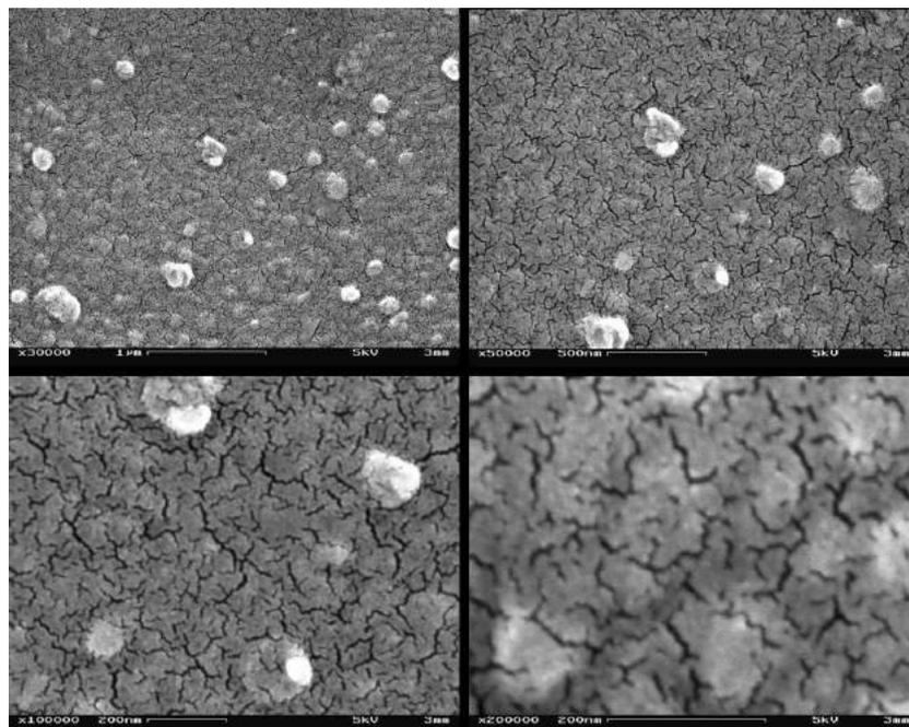
**Figura 5.11** – Micrografías electrónicas de PET (bombardeado con fluencia  $3.10^9$  iones/cm<sup>2</sup>) con marcado químico de 45 minutos y posterior injerto con 2% v/v GMA (PET-R4).
