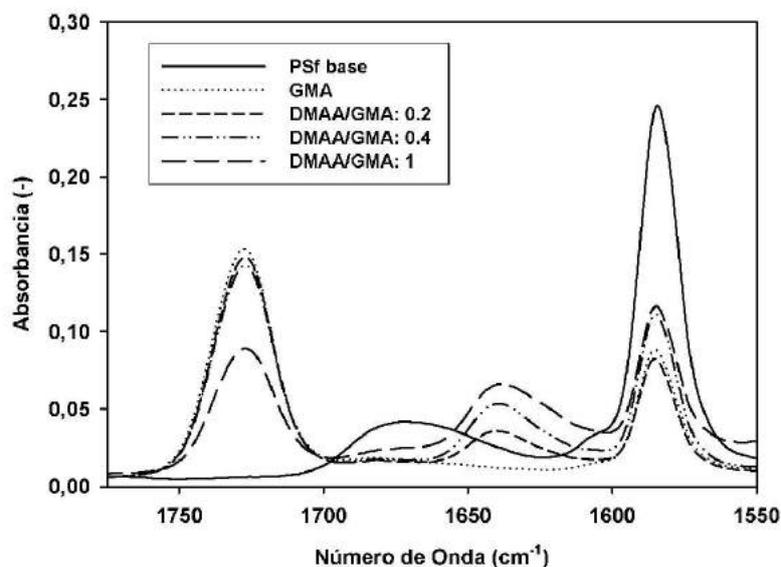
**Figura 4.8** – Espectros IR de las modificaciones incorporadas al polímero base de PSf en función de la relación de monómeros final. *Ampliación en la zona del espectro donde los cambios sobre la superficie son evidentes (entre  $N^{\circ}$  de onda  $1800\text{ cm}^{-1}$  a  $1550\text{ cm}^{-1}$ ).*
