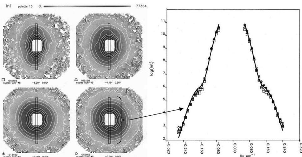
**Figura 5.15** – Resultados típicos obtenidos por SANS para una muestra de PET mediante el análisis por el modelo de Bessel modificado [8]. A partir de las imágenes traducidas por el multidetector (izquierda), se obtiene la gráfica simétrica del logaritmo de la Intensidad en función del vector frecuencia  $Q_y$  (derecha).
