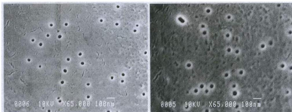
**Figura 5.6** – Micrografías electrónicas (65000 x) de una muestra de PET Hostaphan (fluencia  $3.10^9$  iones Kr/cm<sup>2</sup>) con marcado químico de 30 y de 45 minutos, respectivamente.
