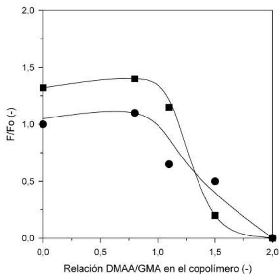
**Figura 2.11** – Efecto de la composición DMAA/GMA del polímero sobre las propiedades de permeación, medido como la relación de flujo respecto al flujo de filtración de agua pura a 0,1 MPa de la membrana de GMA: (●) membranas Epoxi; (■) Membranas-Phe.
