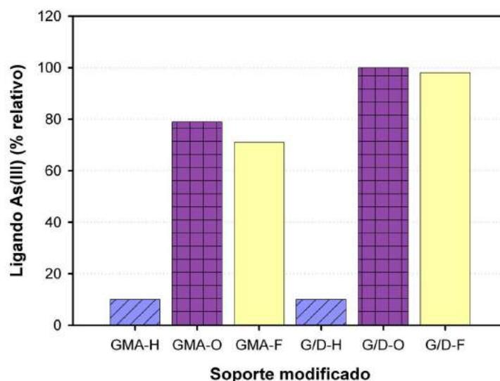
**Figura 7.5** – Densidad de ligando inmovilizado (soporte - precursor) en % relativo. *Soportes:* PSf-GMA y PSf-GD. En bordó cuadriculado, PBMA a partir de APAO +  $\beta$ -ME; en amarillo PBMA a partir de APAV +  $\beta$ -ME; en azul rayado, control por hidrólisis ácida.
