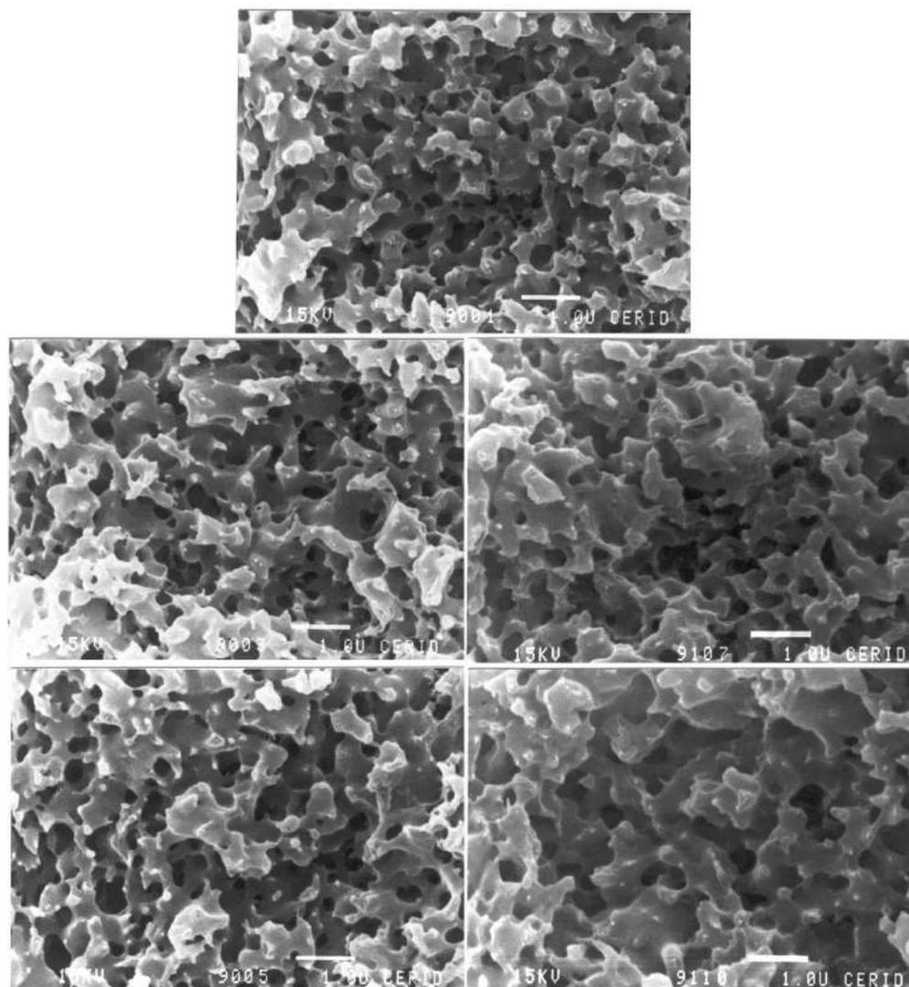
**Figura 2.12** – Fotos SEM de membranas GMA (arriba al centro) y membranas coinjertadas D/G con las siguientes relaciones molares: 0,9 D/G (medio izquierda); 1,1 D/G (medio derecha); 1,5 D/G (abajo izquierda); y 2 D/G (abajo derecha).
