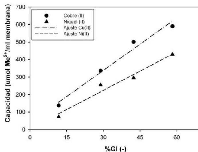
**Figura 4.11** – Curvas de cuantificación de metal (II) en función del grado de injerto. Siendo:  $y_{(\text{Cu}^{2+})} = 9,9694x + 38,9634$  ( $R^2: 0,9788$ ); e  $y_{(\text{Ni}^{2+})} = 7,3174x + 4,3918$  ( $R^2: 0,9666$ ).
