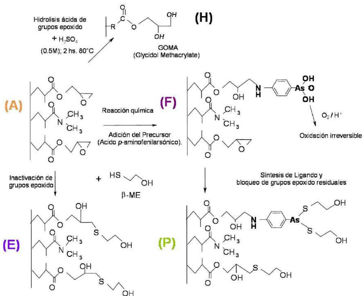
Figura 7.3 – Reacciones de inmovilización y síntesis del ligando.
