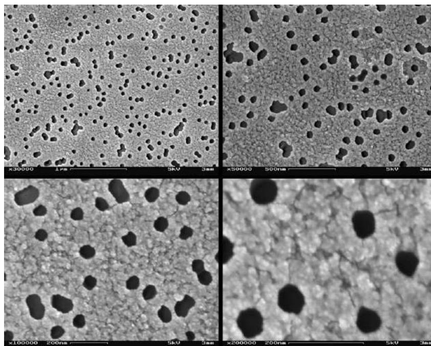
**Figura 5.8** – Micrografías electrónicas de PET bombardeadas con Kr (fluencia de  $3 \cdot 10^9$  iones/cm<sup>2</sup>) con marcado químico de 45 minutos (PET-R1).
