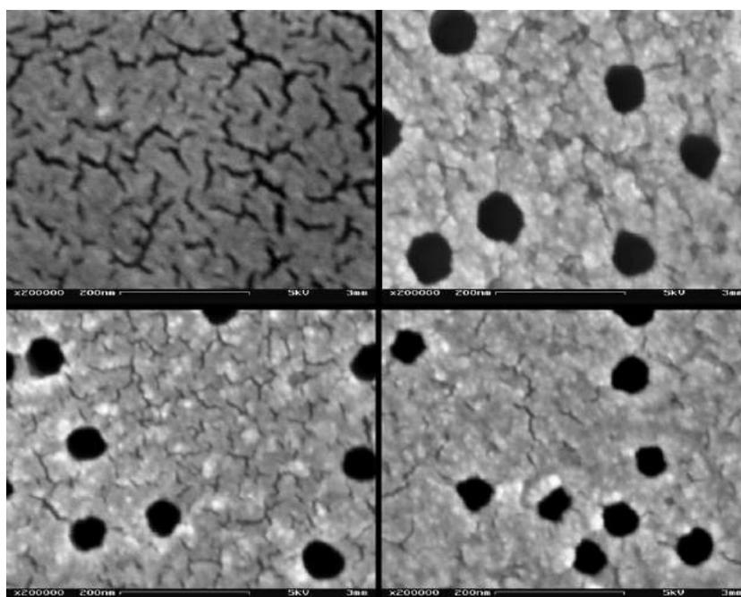
**Figura 5.12** – Evolución del tamaño de poro en las distintas etapas de modificación de PET bombardeado con Kr (fluencia  $3.10^9$  iones/cm<sup>2</sup>): (i) control; (ii) marcado químico de 45 minutos (PET-R1); (iii) injerto con 0,1% v/v GMA (PET-R2); y (iv) modificación con IDA (PET-R3).
