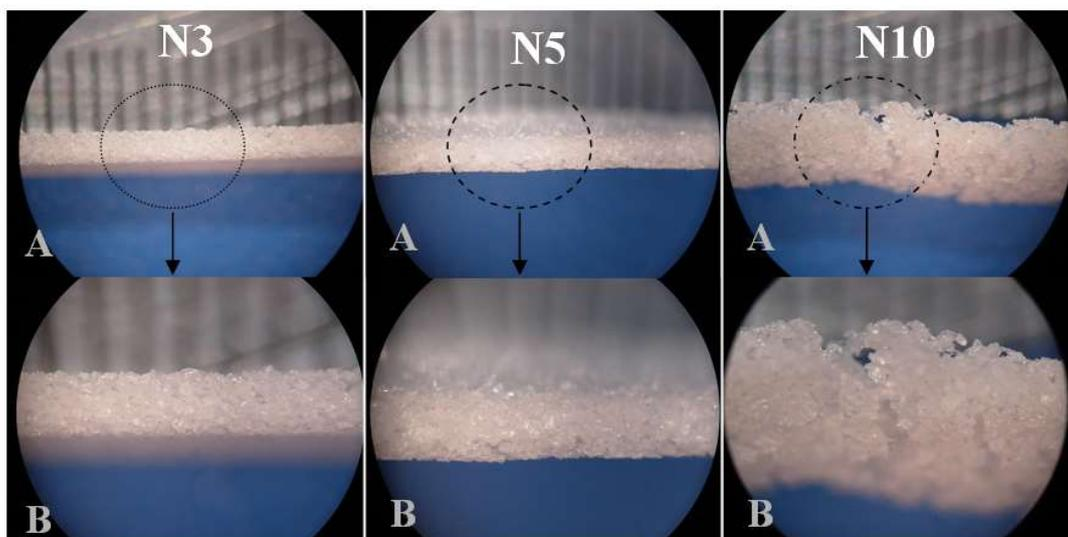
**Figura 3.3** – Fotografías ampliadas de perfiles de PE poroso preirradiado en aire y copolimerizado con AAm: *N3 (10% AAm, mezcla etanol agua), N5 (10% AAm, en agua) y N10 (20% AAm, en agua). Aumento 1,5x (A) y 3x (B) en lupa. En círculo: zona de A ampliada en B.*
