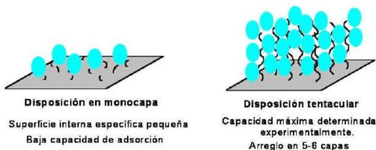
**Figura 2.1** – Disposición en monocapa *vs* Disposición tentacular
