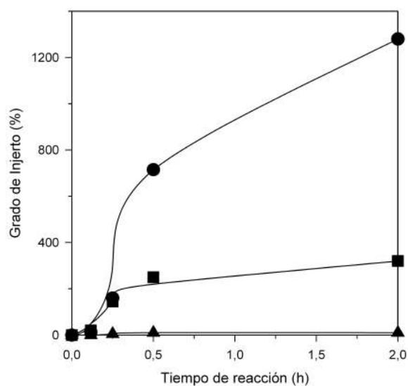
**Figura 2.6** – Efecto del tiempo de reacción de injerto en el grado de injerto con soluciones al 10% v/v de monómeros y mezcla de monómeros sobre membranas de fibra hueca de PE: (●) GMA, (■) D/G (1:1), (▲) DMAA.
