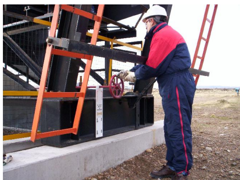
Acople de la traba de seguridad a través del movimiento del volante de accionamiento.
