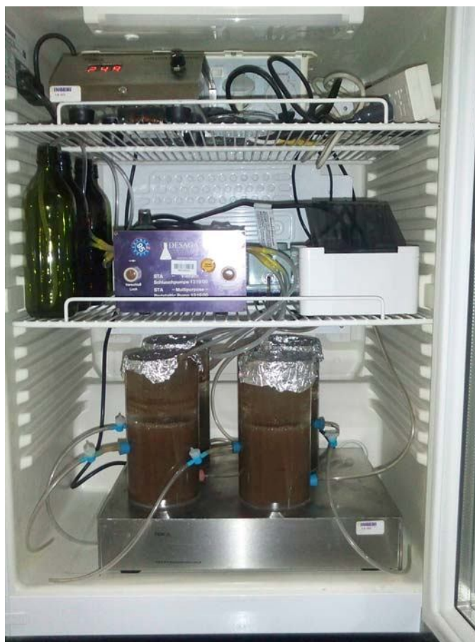
Figura 42. Reactores a escala de laboratorio empleados en este estudio. Los reactores se encuentran dentro de una cámara termostatzada, dispuestos sobre una plataforma con agitación magnética. También se observa el sistema automatizado de aireación y alimentación.
