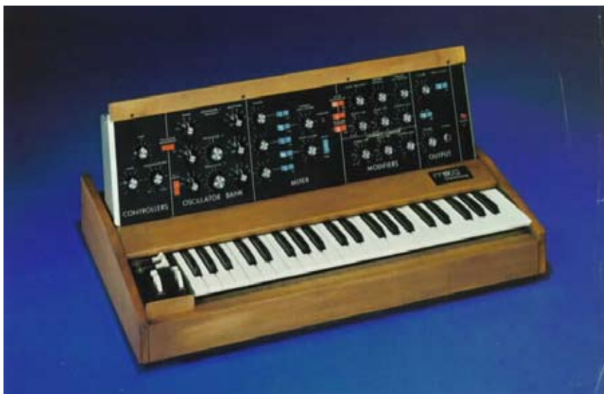
FOTO 3. EL MINIMOOG CONSTRUIDO CON PLAQUETAS DE CONEXIÓN, SIN CABLES A LA VISTA. ERA PORTÁTIL Y PERMITIÓ REALIZAR PRESENTACIONES EN VIVO.
