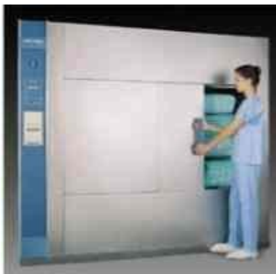
Fig. 26: Frente de un autoclave de vapor para la industria farmacéutica.
