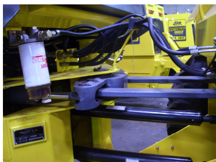
Figura 2.2. La articulación de un tractor Zanella
