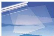
**PET de film**, todas las películas fotográficas de rayos X y de audio están hechas de este polímero. En este caso se utiliza el PET estirado biaxialmente, que es ópticamente traslucido, brillante, de excelente resistencia mecánica, buenas propiedades dieléctricas y coeficiente de fricción, resistente e inerte a muchos agentes químicos. Todas estas propiedades le confieren una versatilidad excepcional en comparación con otras películas poliméricas. Actualmente se las comercializa como films
