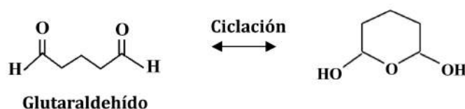
Fig.5.2. Estructura y ciclación del glutaraldehído en soluciones diluidas y en el rango de pH de 3 a 8.
