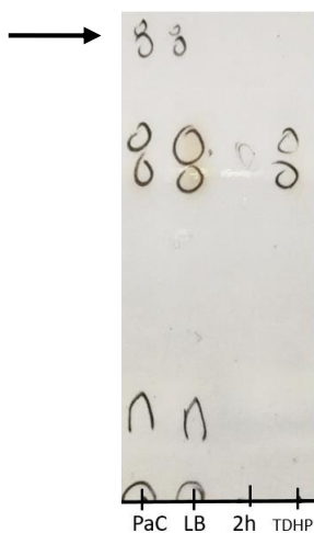
Figura 6. 25: CCD correspondiente a la reacción con 2.h. PaC: Escherichia coli PaDERA C49M C-His Lb: Escherichia coli LbDERA C42M E78K C-His
