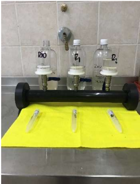
Figura 11: Preparación de las muestras para lectura espectrofotométrica antes de se realice la acidificación.
