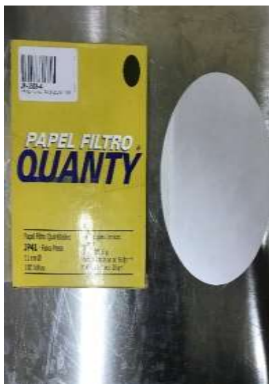
Figura 8: Filtrado 1 250 ml de muestra homogeneizados se los filtró utilizando un filtro de 28 \mu\text{m} de tamaño de poro para quitar interferencias de la muestra.
