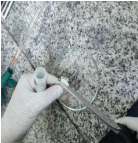
Figura 12: Preparación de las muestras para lectura espectrofotométrica antes de se realice la acidificación.
