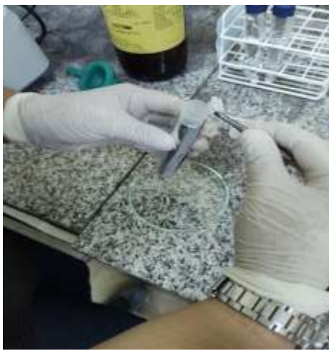
Figura 12: Preparación de las muestras para lectura espectrofotométrica antes de se realice la acidificación.
