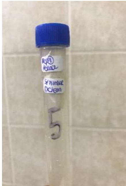
Figura 11: Preparación de las muestras para lectura espectrofotométrica antes de se realice la acidificación.
