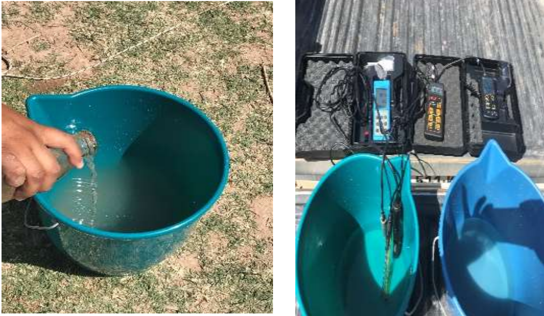
Figura 5: Determinación de parámetros físicos de muestra integrada
