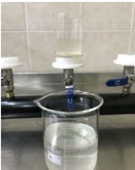
Figura 10: Filtración 2: filtración con filtros de fibra de vidrio GF/C (0,47 \mu\text{m} ).
