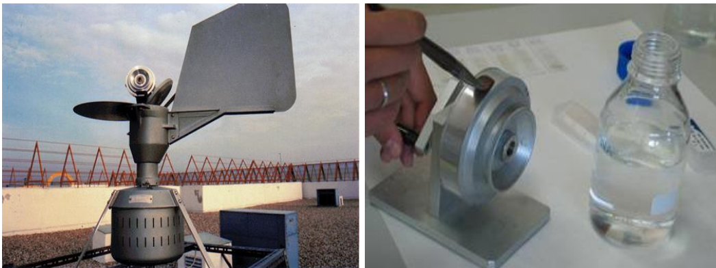
Fig. 3: Trampa de esporas Burkard y aplicación de fluido siliconado.
