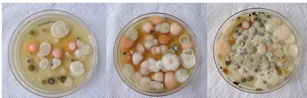
Fig. 34: Ensayo sobre medio PDA con Cloranfenicol (0,1 g/L) y Diclorán (2 mg/L), volumen empleado: 100L y velocidad empleada: 30L/min.
