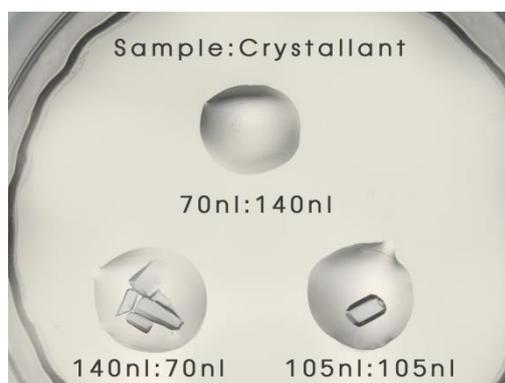
**Figura 22.** Fotografía de las gotas realizadas por el robot *TTP LabTech Mosquito Crystal nanodispenser* y las relaciones de muestra (*sample*) y solución de cristalización (*Crystallant*) ensayados para la cristalización del Fab128.1.
