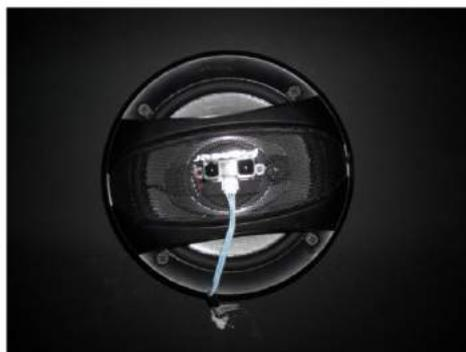
**Figura 9.11:** *Se observa un parlante ubicado en el techo de la instalación con el sensor Sharp adosado, ambos apuntando hacia abajo.*
