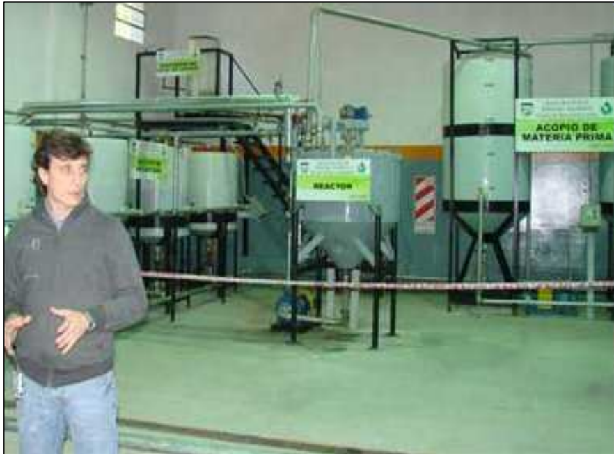
Imagen N° 18: La planta municipal de producción de biodiesel de Malvinas Argentinas fue inaugurada en el 2009 y tiene capacidad para producir 12.000 litros mensuales.
