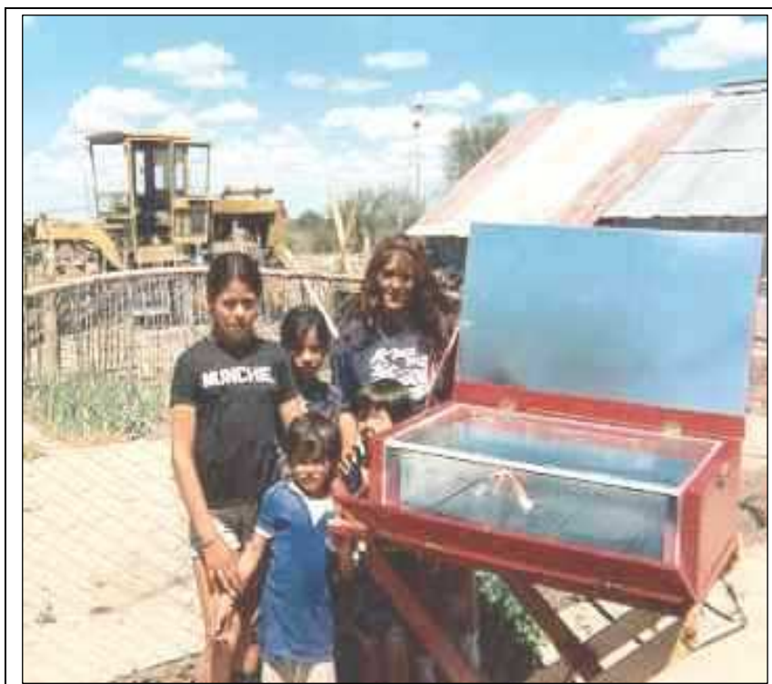
Imagen N° 1: Los hornos construidos en el taller presentaban una doble ganancia de radiación solar al incorporar un reflector complementario en la parte inferior delantera.
