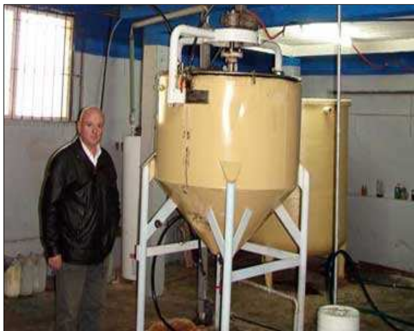
Imagen N° 17: La primera planta experimental contaba únicamente con un reactor que fue construido con un rezago de la industria alimenticia.
