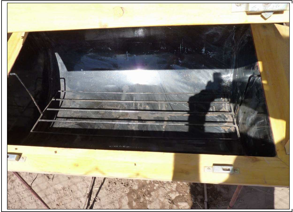
Imagen N° 14: La cámara de cocción pintada de negro mostró un mejor rendimiento que la plancha de aluminio en los hornos.
