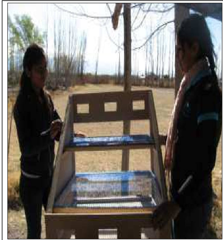
Imagen N° 11: Para facilitar la carga y descarga de los vegetales en el secadero se le agregó una puerta de acceso posterior.
