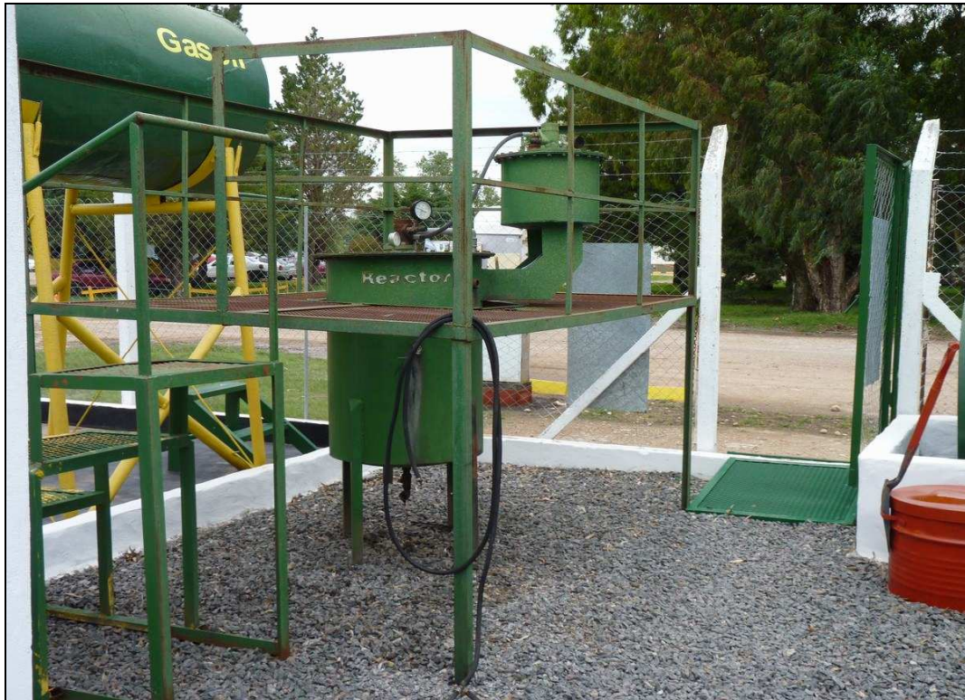
Imagen N° 22: El reactor original del la Planta de Biodiesel de la EATA tenía capacidad de 300 litros y funciona por agitación.
