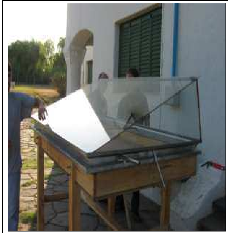
Imagen N° 6: Destilador solar con cúpula asimétrica reemplazó al prototipo original.
