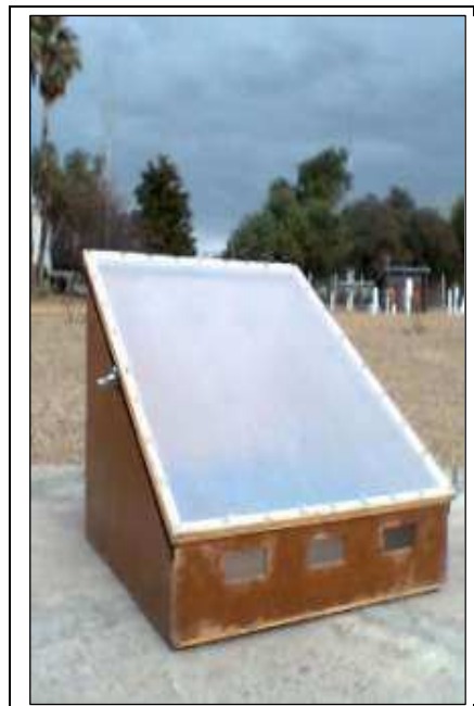
Imagen N° 8: Secador solar con ventanas. El prototipo estaba cubierto por una plancha de policarbonato que podía ser removida con el fin de introducir los vegetales para su secado.
