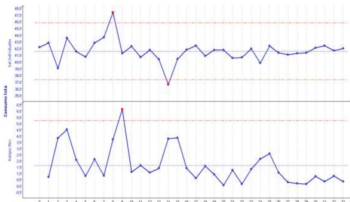
Figura 26. Gráfica IMR de consumo energético total del horno de fusión en el período septiembre 2017-octubre 2020. Fuente: Elaboración propia.
